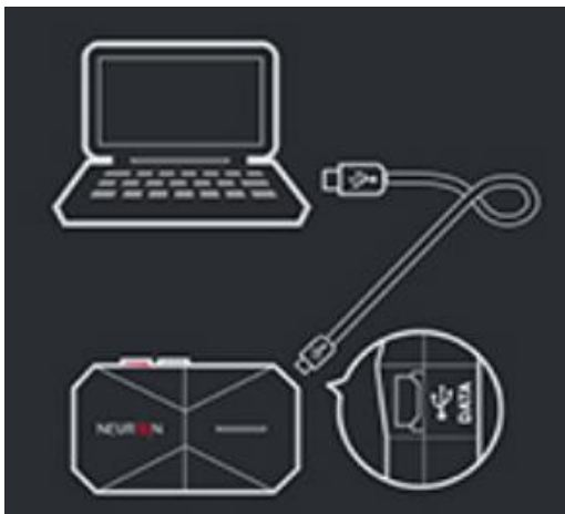
Slika 42. Povezivanje Perception Neuron-a sa računalom preko koncentratora [37]
