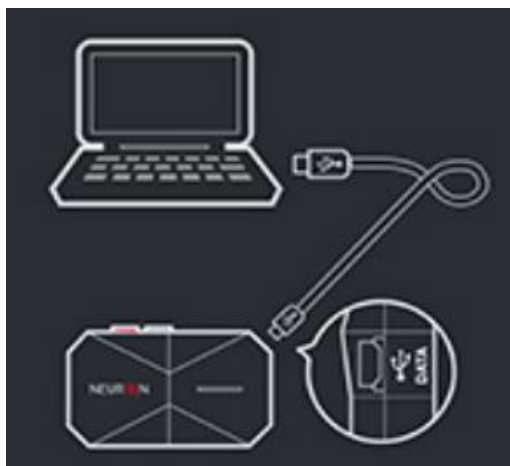
Slika 42. Povezivanje Perception Neuron-a sa računalom preko koncentratora [37]
