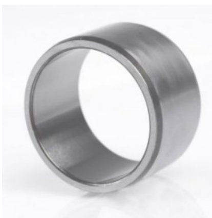
Slika 57. Prsten za ispitivanje kliznog trošenja oznake NTN 1R30X35X17 [33]
