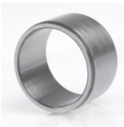
Slika 57. Prsten za ispitivanje kliznog trošenja oznake NTN 1R30X35X17 [33]
