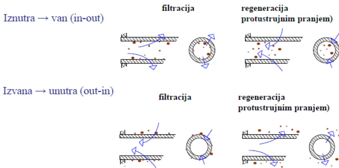
Slika 6. Smjerovi strujanja na membrani u formi šupljeg vlakna
