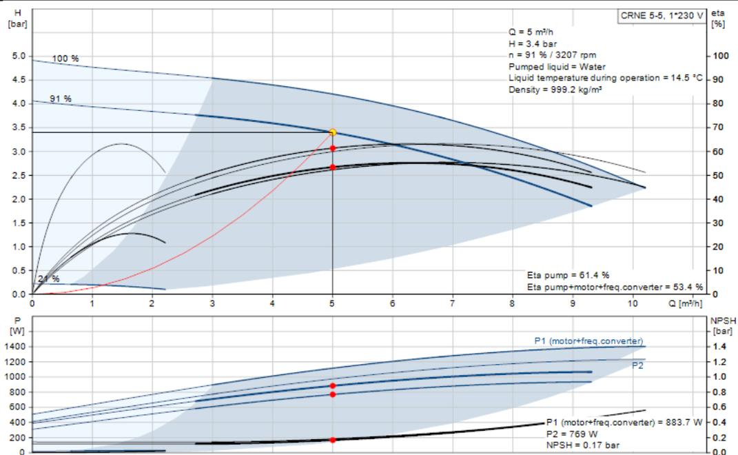
Slika 24. Radna karakteristika pumpe P<sub>3</sub>
