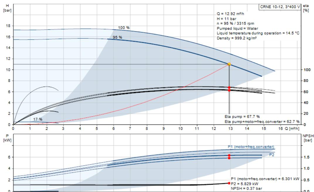
Slika 22. Radna karakteristika pumpe P<sub>1</sub>
