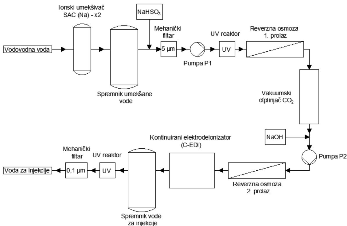
Slika 13. Shematski prikaz tehnološkog postupka pripreme vode za injekcije
