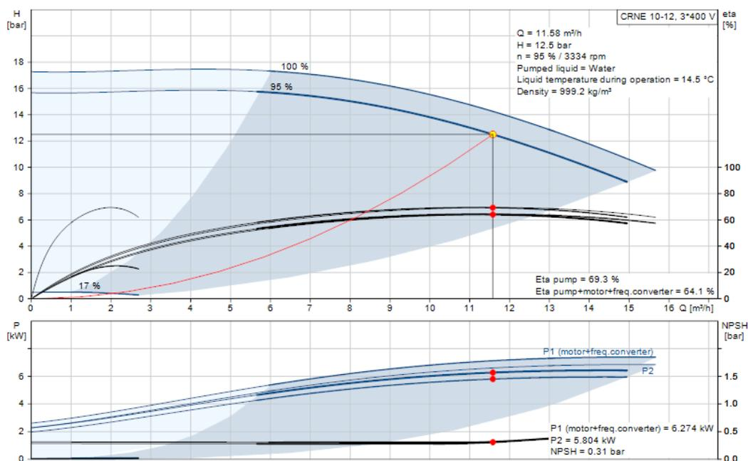
**Slika 23. Radna karakteristika pumpe P<sub>2</sub>**
