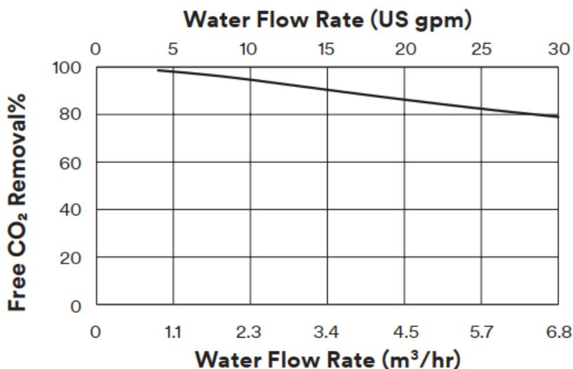
Slika 17. Krivulja s nominalnim vrijednostima uklanjanja CO<sub>2</sub>
