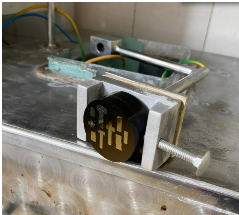
Slika 19. Uzorak stegnut u čeljusti prije nagrizanja
