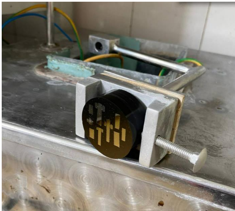
Slika 19. Uzorak stegnut u čeljusti prije nagrizanja
