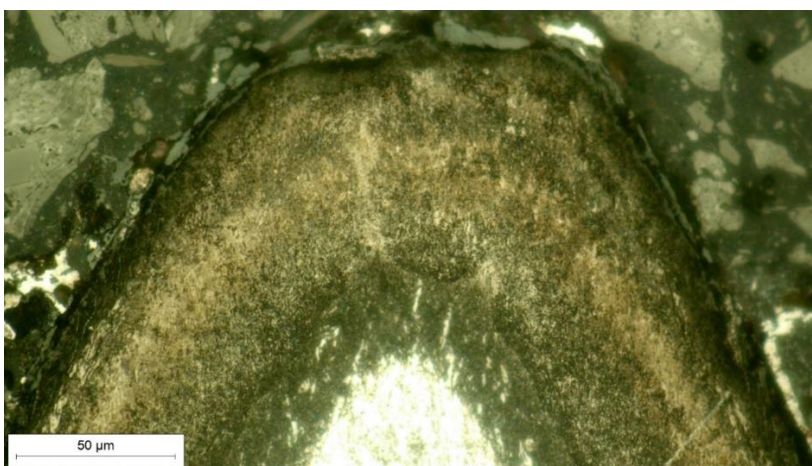
Slika 27. Vrh navoja M5, nitrokarburirano 6h, povećanje 500x
