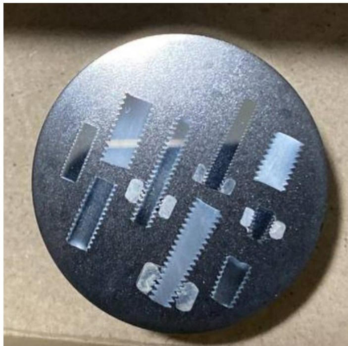
Slika 18. Uzorak zaliven u vodljivu polimernu masu
