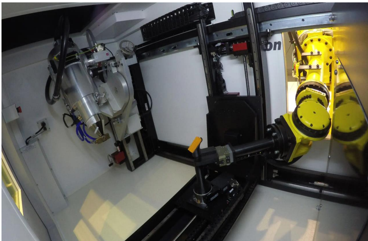
Slika 9 Rotacijski stol umjeravan vanjskim manipulatorom [9]
