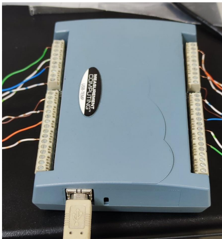
Slika 30 Uređaj za mjerenje temperature na termistorima
