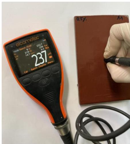
Slika 26. Postupak mjerenja debljine epoksidnog premaza
