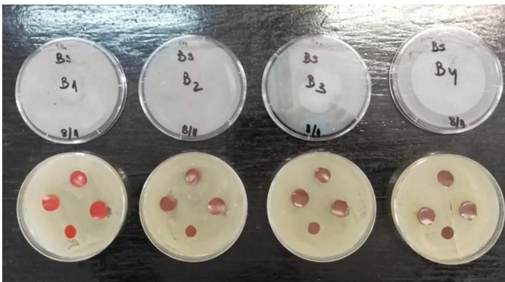
**Slika 41. Uzorci epoksidne smole u bakterijskoj suspenziji bakterije *Bacillus subtilis* nakon 24 sata izlaganja**
