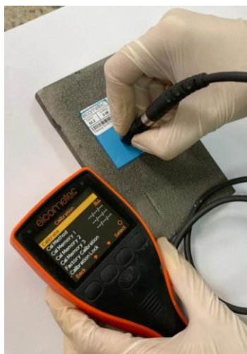
Slika 25. Postupak umjeravanja uređaja Elcometer 456
