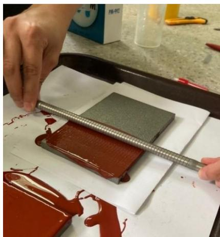
Slika 23. Nanošenje epoksidnog premaza s dodatkom nanočestica aluminija
