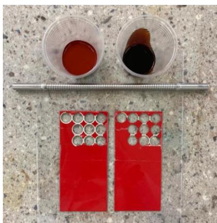
**Slika 34. Potrebne komponente (epoksidna smola, otvrdnjivač, aplikator)**
