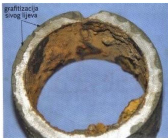
Slika 4. Selektivna korozija sivog lijeva [3]
