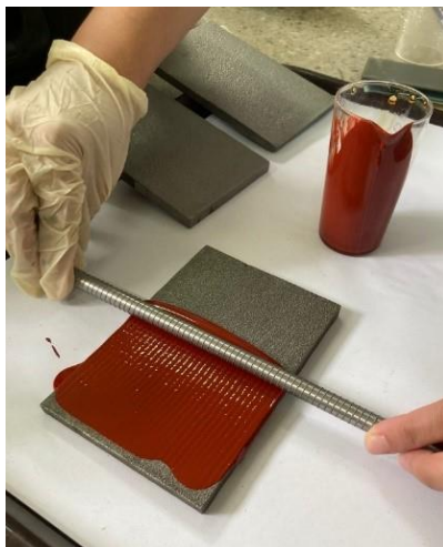
Slika 20. Nanošenje čistog epoksidnog premaza na uzorak sivog lijeva
