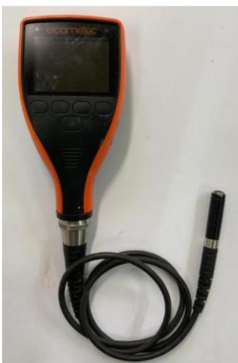
Slika 24. Uređaj Elcometer 456
