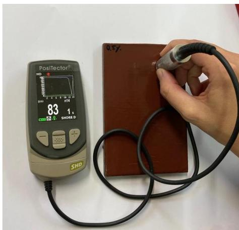
Slika 27. Postupak ispitivanja tvrdoće epoksidnog premaza
