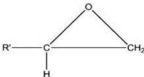
Slika 7. Struktura epoksidnog prstena [8]
