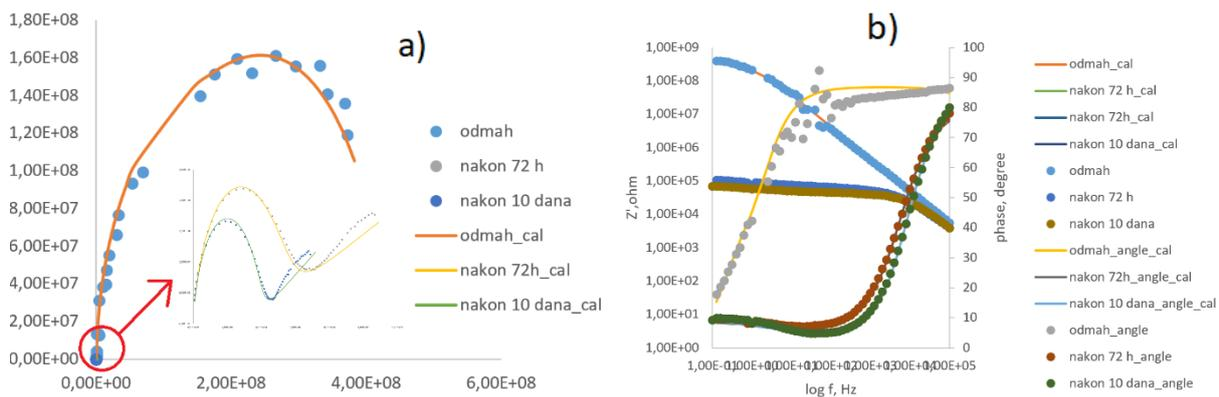
Slika 30. Nyquistov dijagram (a) i Bodeov dijagram (b) za čisti epoksidni premaz
