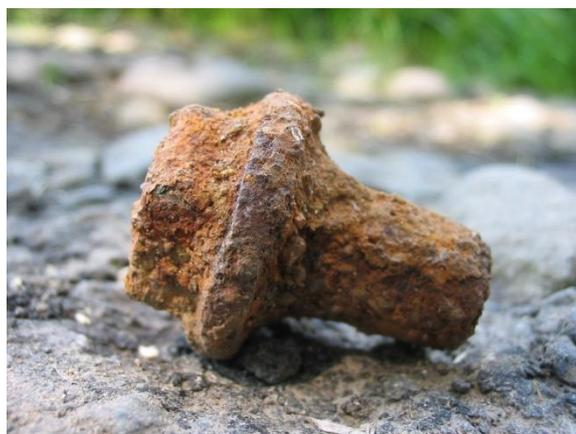
**Slika 3. Opća korozija sivog lijeva [6]**
