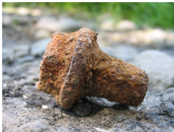
Slika 3. Opća korozija sivog lijeva [6]
