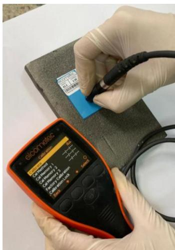
Slika 25. Postupak umjeravanja uređaja Elcometer 456
