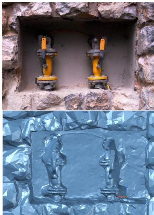
Slika 4 : Prikaz dobivene mreže od 3D skena
