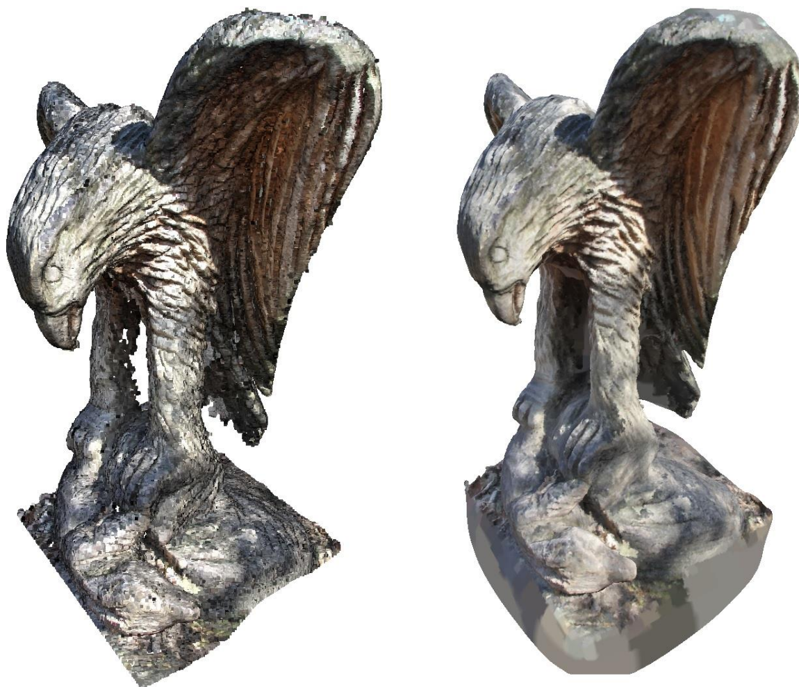
Slika 7 : Poissonova rekonstrukcija površine [3]
