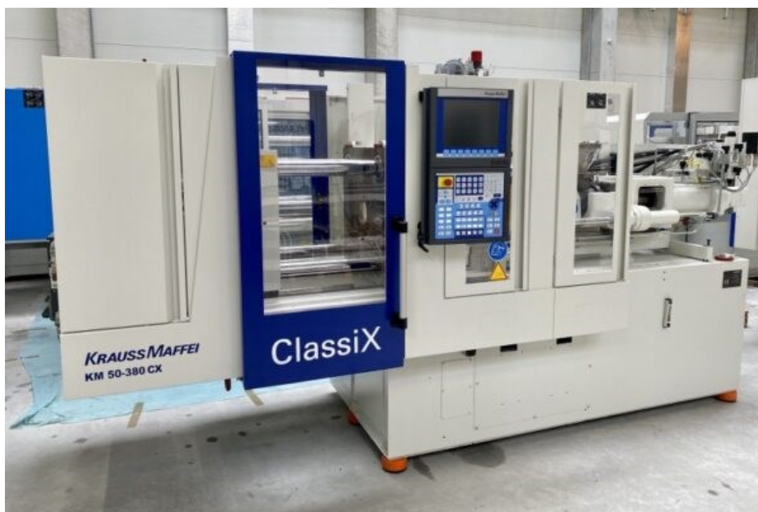
Slika 28 Stroj za injekcijsko prešanje (ubrizgavalica) [25]
