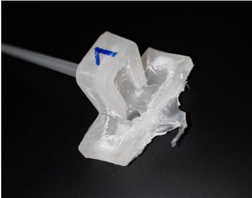
Slika 32 Proizvod načinjen u FDM kalupnom umetku
