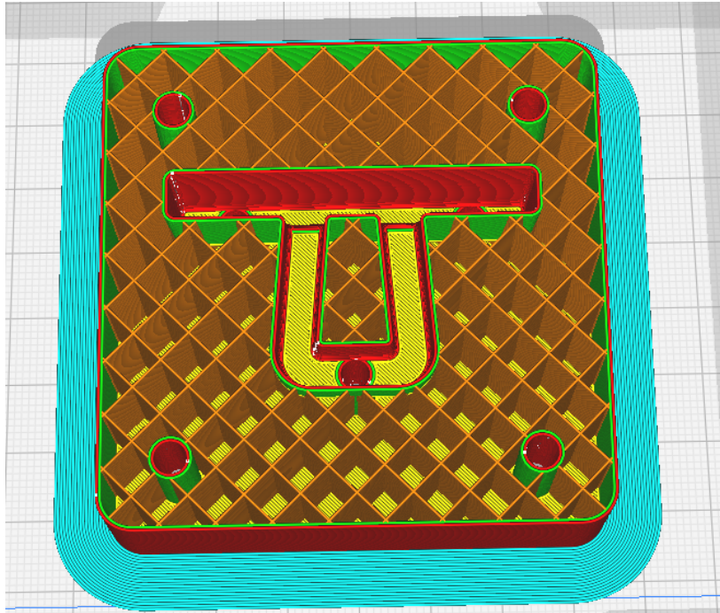
Slika 13 Presjek FDM/FFF 3D ispisa
