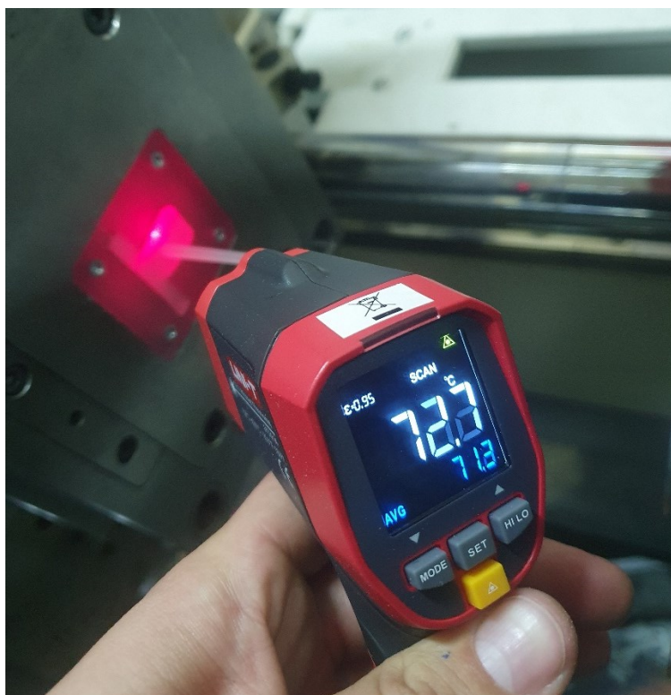
Slika 30 Mjerenje temperature kod otvaranja kalupa
