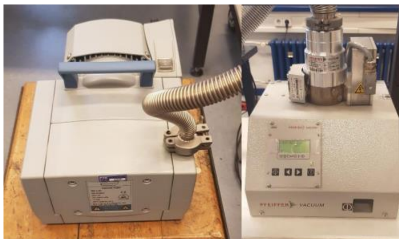
Slika 22. Membranska vakuum pumpa (lijevo) i turbomolekularna vakuum pumpa (desno)
