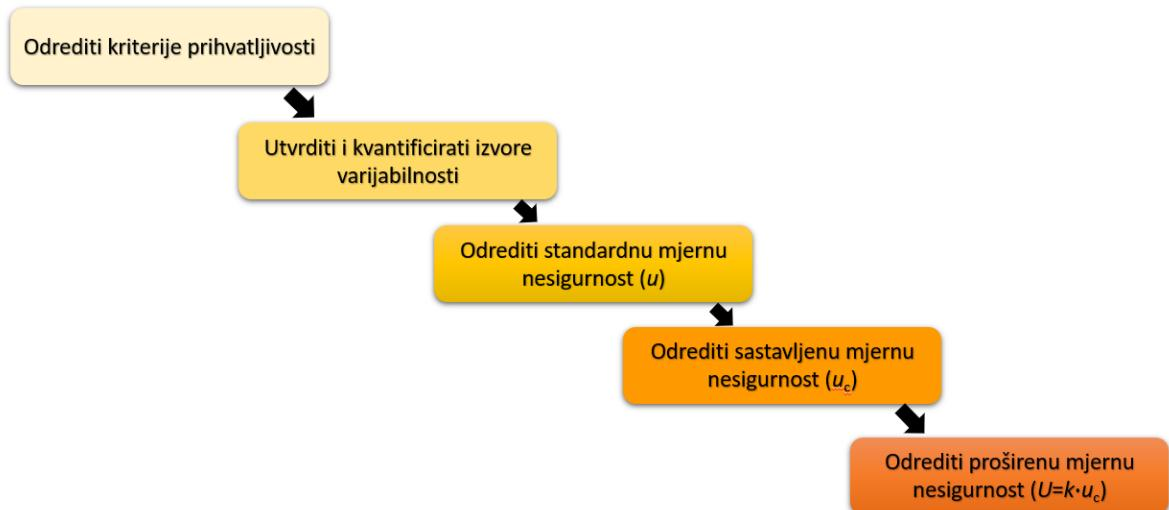
**Slika 21. Shematski prikaz procedure određivanja mjerne nesigurnosti**
