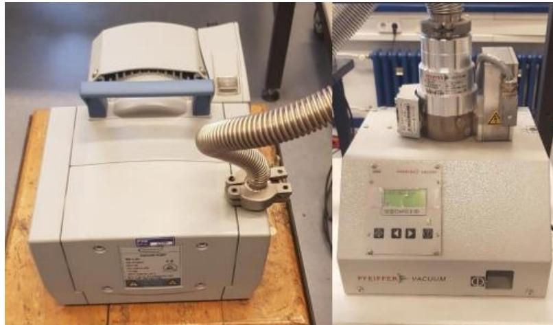
Slika 22. Membranska vakuum pumpa (lijevo) i turbomolekularna vakuum pumpa (desno)
