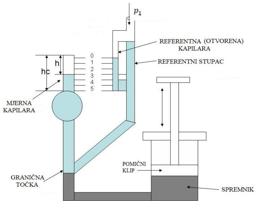
Slika 7. McLeodov vakuummetar [9]
