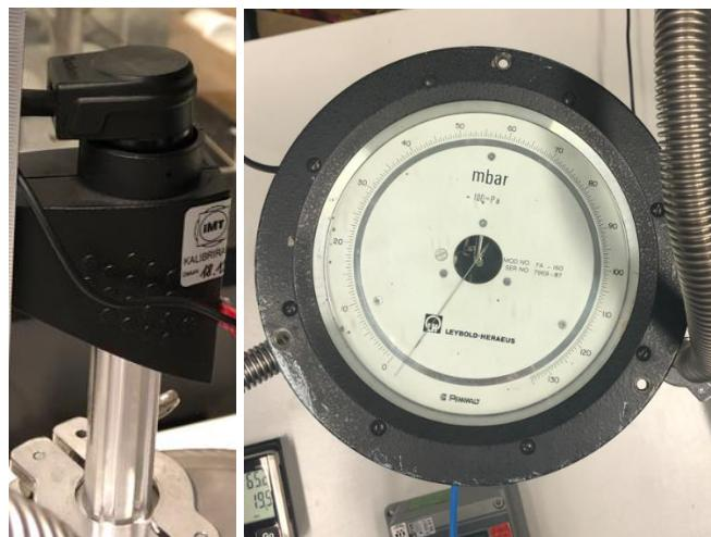
**Slika 24. Etalonski digitalni vakuummetar (lijevo) i ispitni analogni vakuummetar (desno)****Tablica 2. Podaci o digitalnom etalonskom i analognom ispitivanom mjerilu tlaka**
