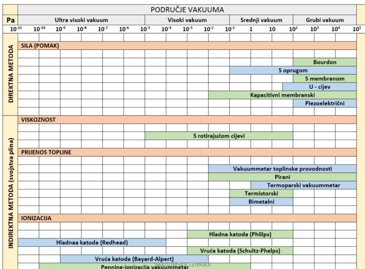
Slika 2. Mjerila vakuuma s obzirom na područje vakuuma [2]
