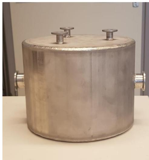
**Slika 23. Vakuum komora**
