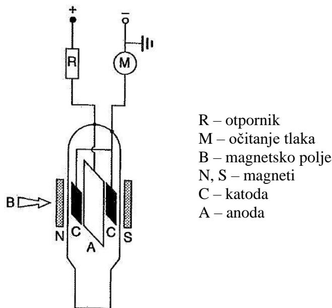
Slika 12. Penningov vakuummetar [3]
