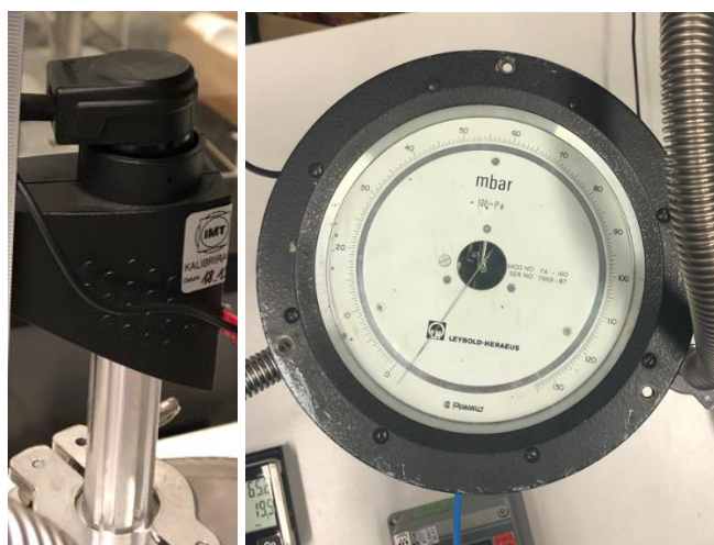
Slika 24. Etalonski digitalni vakuumetar (lijevo) i ispitni analogni vakuumetar (desno)
