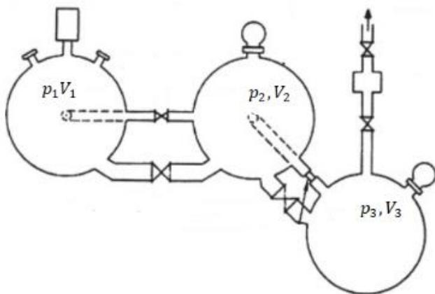
**Slika 18. Umjeravanje mjerila protokom plina kroz kaskadne komore [4]**
