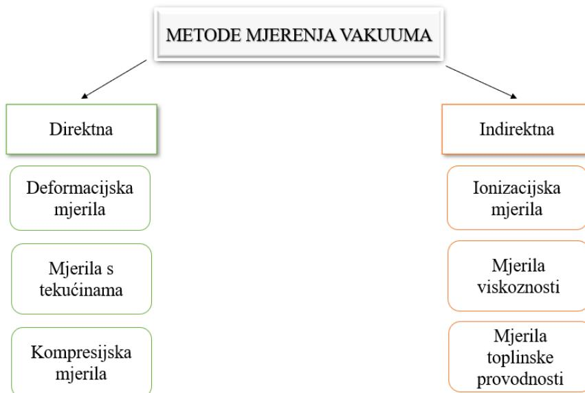
**Slika 1. Podjela metoda mjerila vakuuma**
