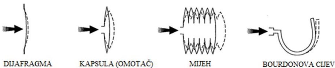
Slika 3. Česti mehanički deformacijski elementi [3]
