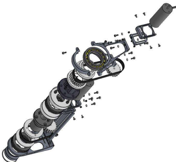
Slika 42. Izometrički prikaz 3D modela rotirajućega klizača u eksplodiranom prikazu
