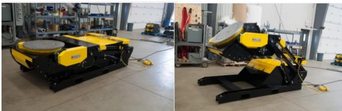
Slika 2.7. Hidraulička naprava za pozicioniranje tvrtke Welding Automation [8]
