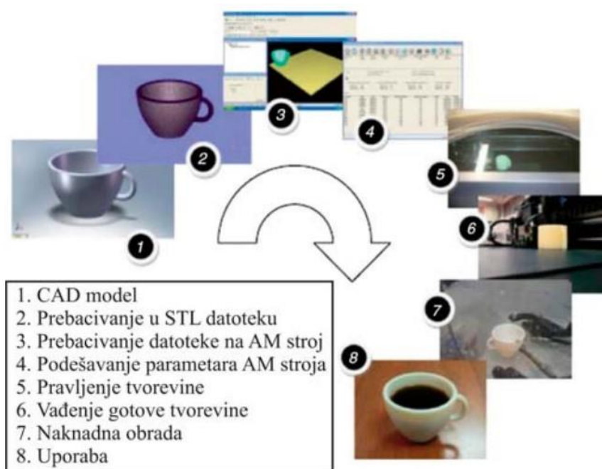
Slika 2. Faze izrade AM postupcima [2]
