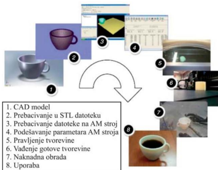
Slika 2. Faze izrade AM postupcima [2]
