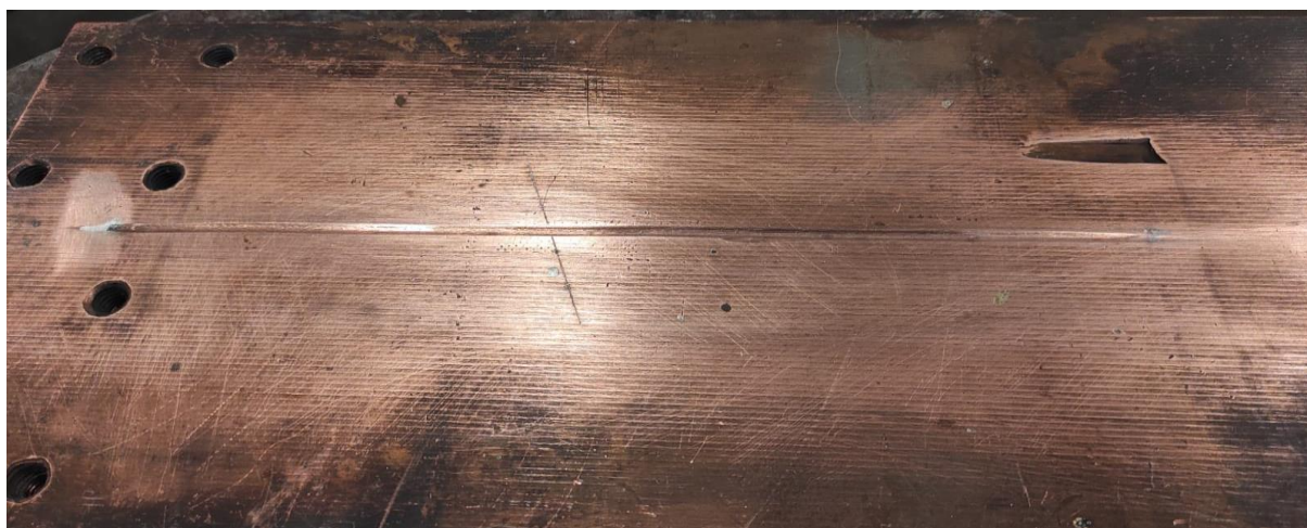
Slika 28. Bakrena podloška s žljebom
