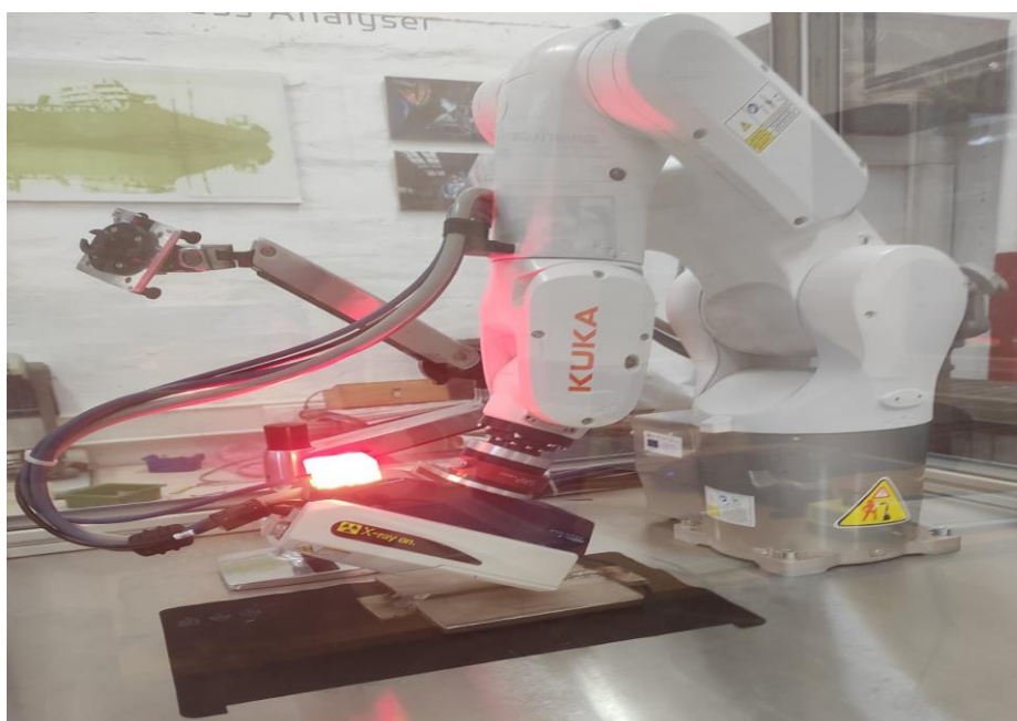
Slika 39. Uredaj za mjerenje zaostalih napreznja \mu -X360s
