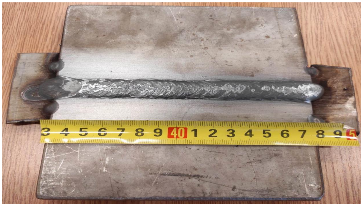
Slika 38. Izgled gornje površine i lica zavara MIG uzorka
