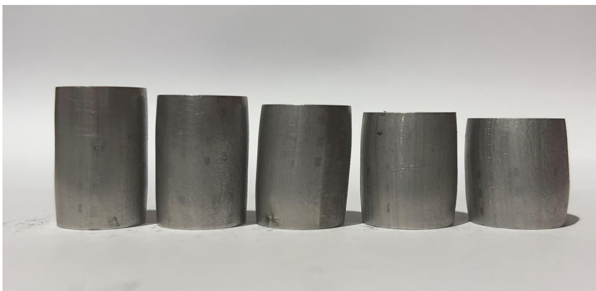
Slika 24. Cilindrični uzorci nakon sabijanja batom, legura AlMgSi1
