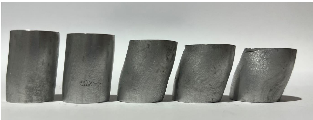
Slika 36. Cilindrični uzorci nakon sabijanja hidrauličnom prešom, legura AlCuBiPb
