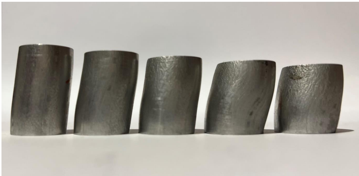
Slika 33. Cilindrični uzorci nakon sabijanja hidrauličnom prešom, legura AlMgSi1
