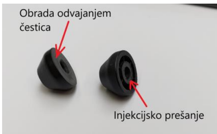
Slika 7. Kotačići vodilice dobiveni obradom odvajanjem čestica i injekcijskim prešanjem
