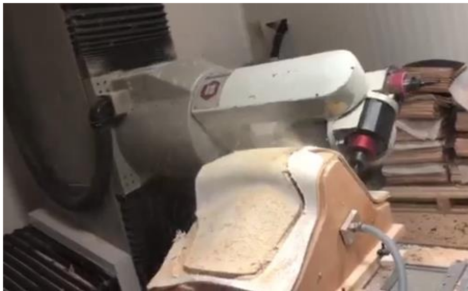
Slika 25. CNC izrezivanje konture školjke stolca „Oblikant“
