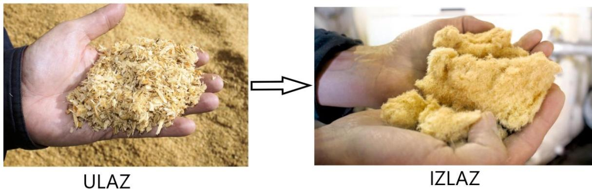
**Slika 11. Dobivanje drvnih vlakana [9]**
