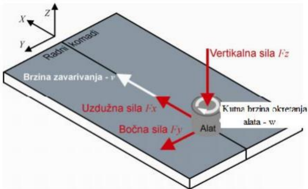
Slika 9. Prikaz djelovanja sila F_x , F_y i F_z [12]
