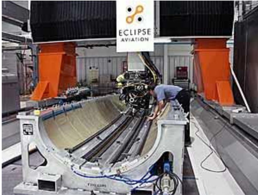
Slika 6. FSW zavarivanje aluminijskih poprečnih greda i poluga za kabinske ploče[8]
