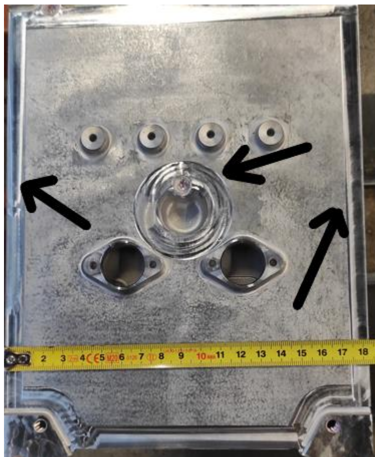
Slika 36. FSW zavareni spojevi na obratku
