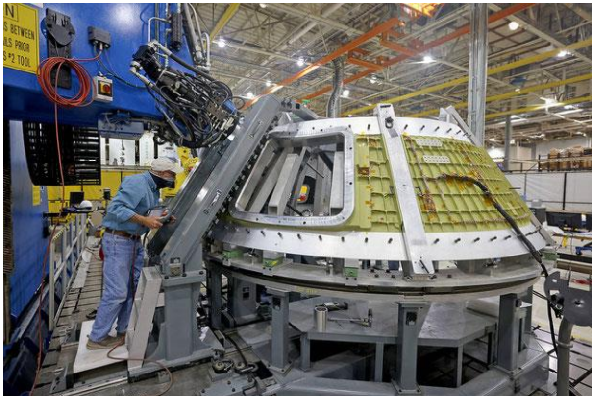
Slika 31. Zavarivanje modula svemirske letjelice Orion[23]
