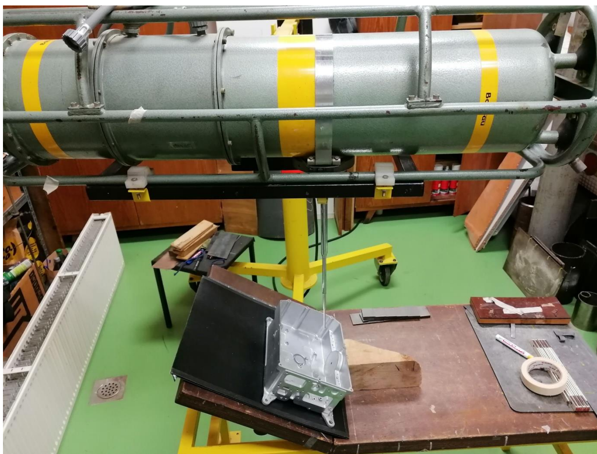
Slika 43. Postupak radiografskog ispitivanja pomoću RTG uređaja Balteau 300D
