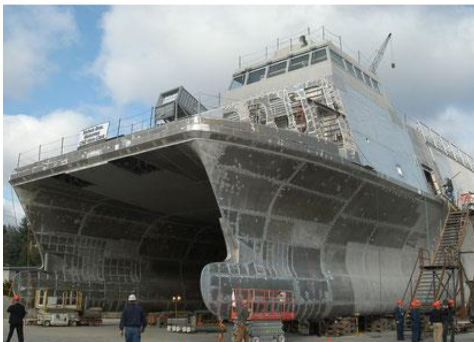
Slika 28. Aluminijski paneli zavareni FSW-om na brodu X-Craft[23]
