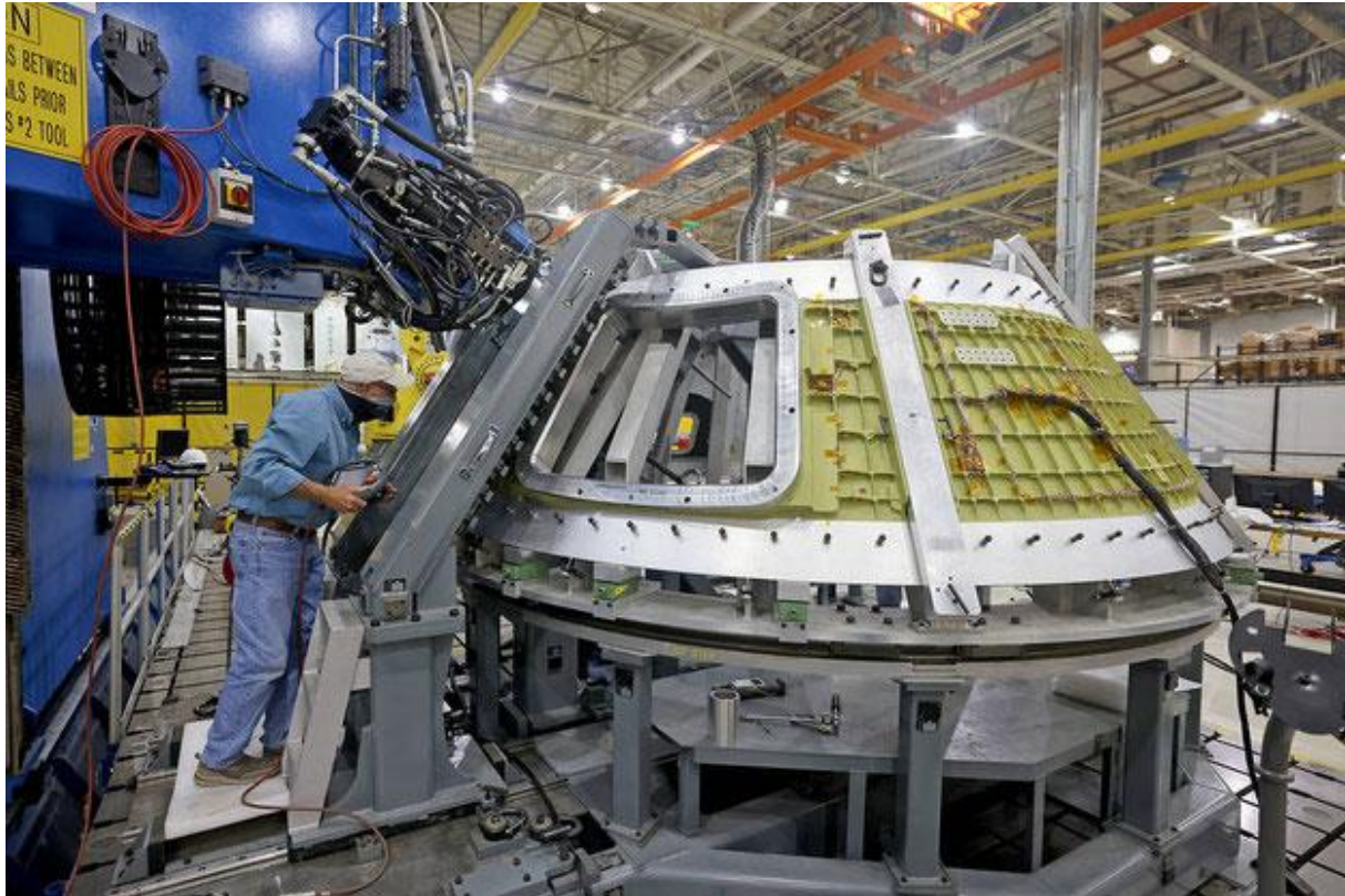
Slika 31. Zavarivanje modula svemirske letjelice Orion[23]
