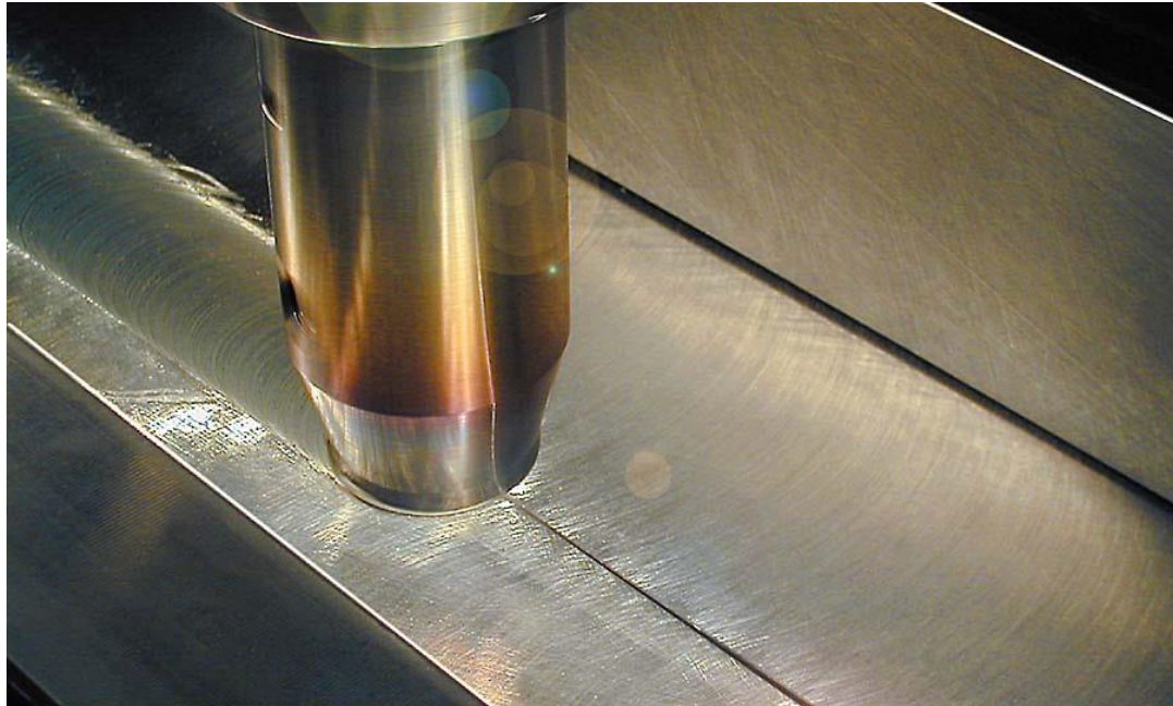
Slika 12.Faza formiranja FSW zavarenog spoja[17]
