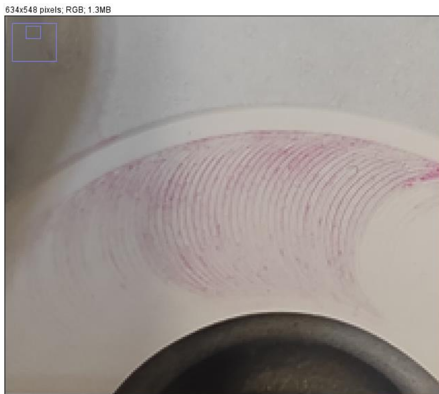
Slika 42. Površina na kojoj su vidljive indikacije u programu ImageJ
