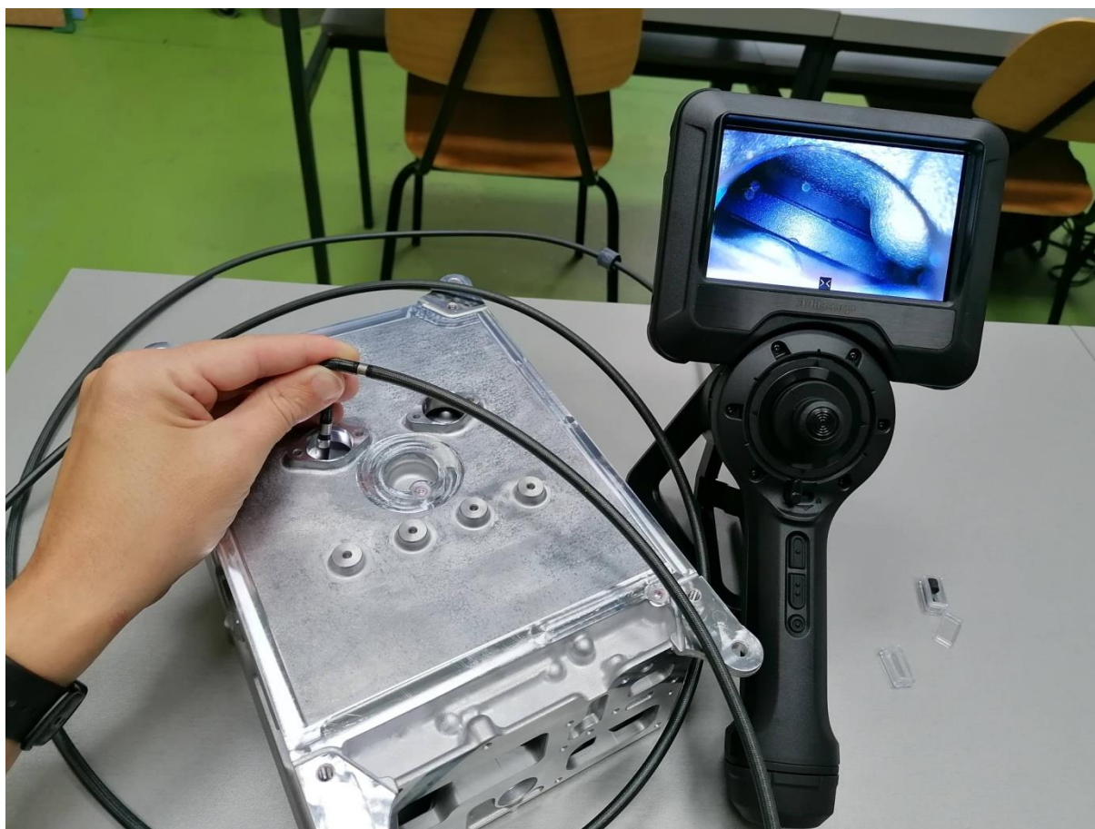
Slika 47. Vizualna kontrola pomoću videoscopa Mitcorp X750
