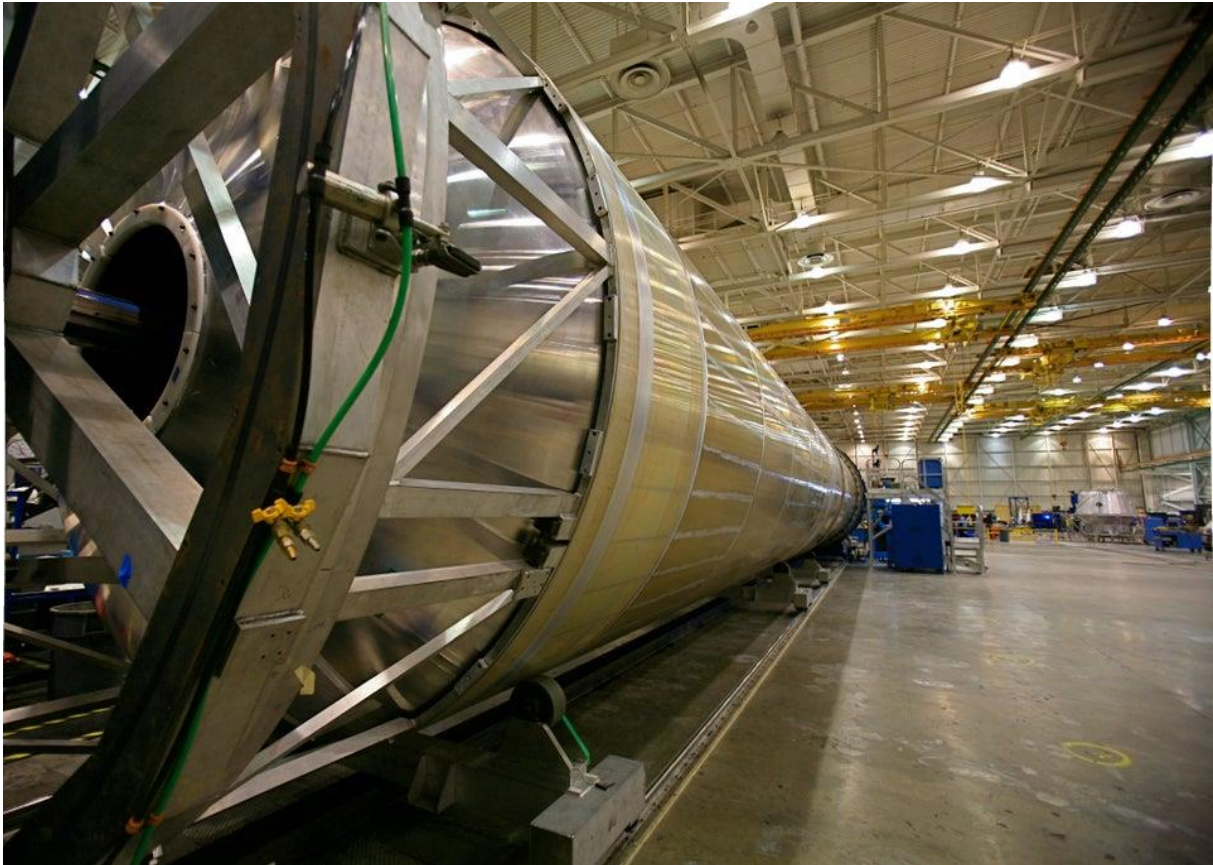
Slika 30. Uzdužni i kružni zavareni spojevi na raketi Falcon 9 SpaceX[24]
