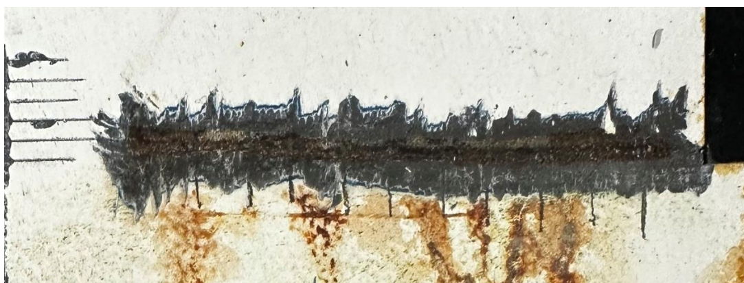
Slika 39. Postupak ocjenjivanja stupnja korozije oko ureza
