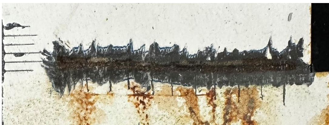
Slika 39. Postupak ocjenjivanja stupnja korozije oko ureza
