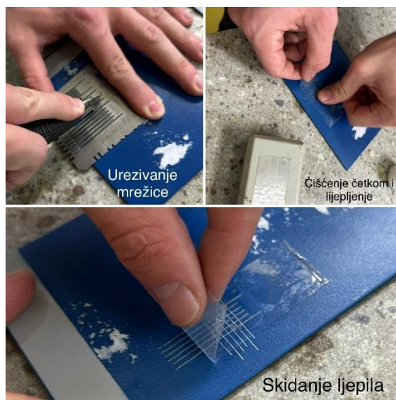
Slika 28. Postupak „Cross cut“ testa
