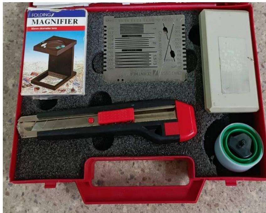
Slika 25. Set za ispitivanje prionjivosti urezivanjem mrežice
