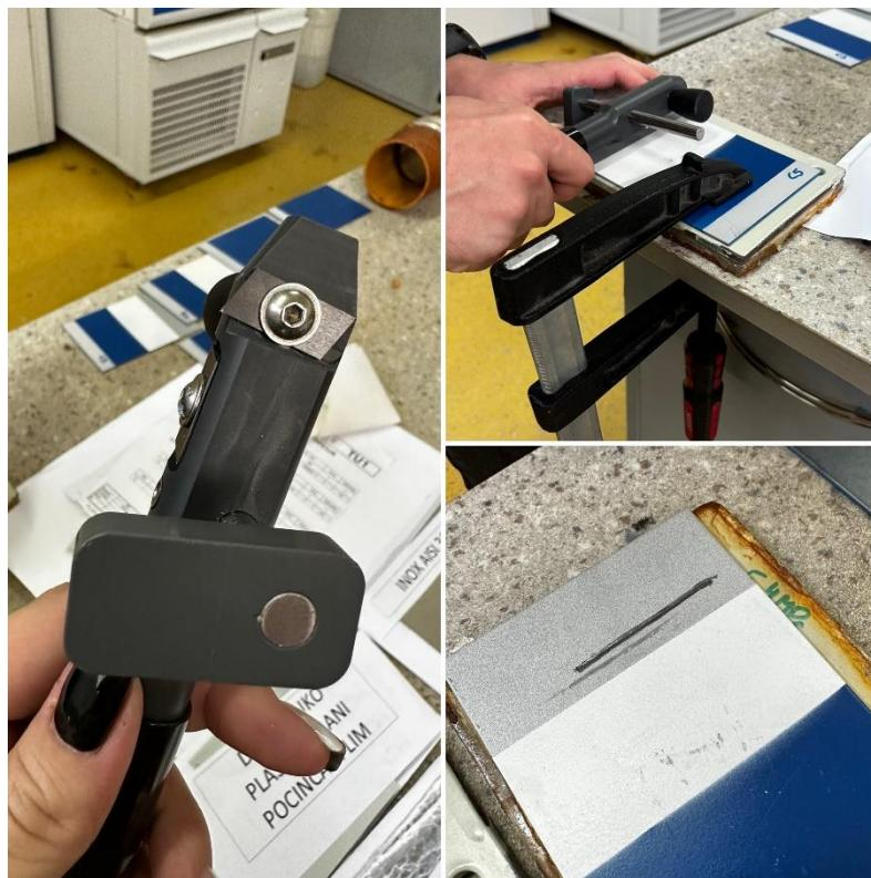
Slika 36. Postupak izrade ureza prije slane komore
