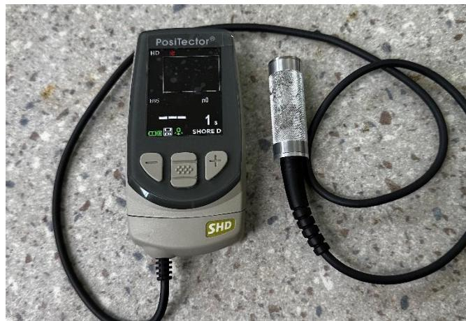
Slika 32. Uređaj za mjerenje tvrdoće, Shore D metoda
