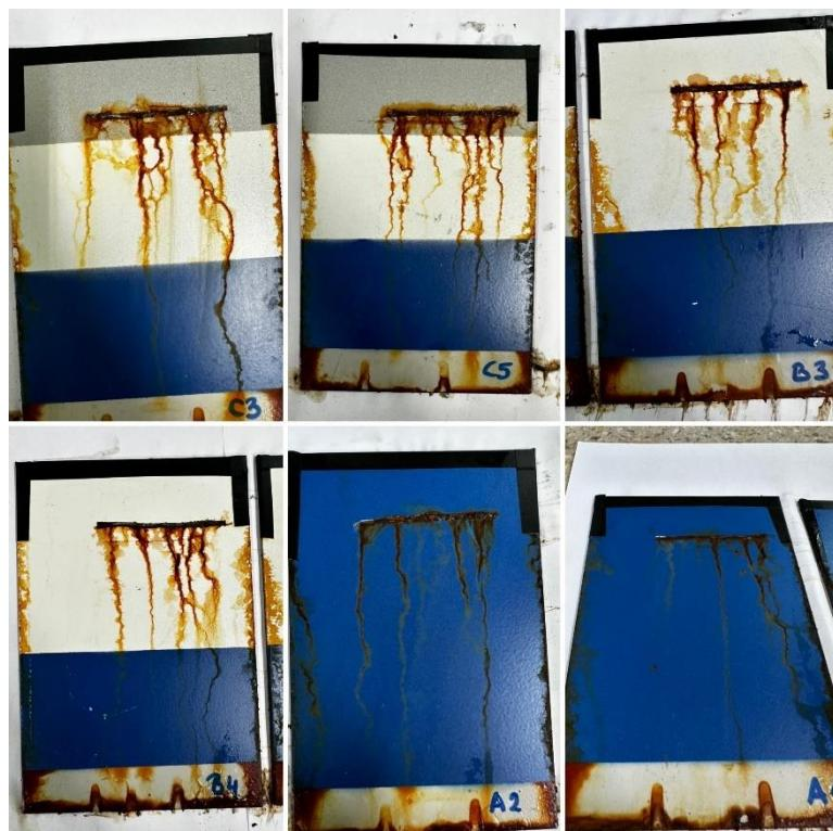
Slika 38. Ispitni uzorci nakon 144 h u slanoj komori
