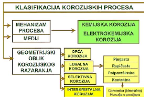
Slika 4. Vrste korozije [5]
