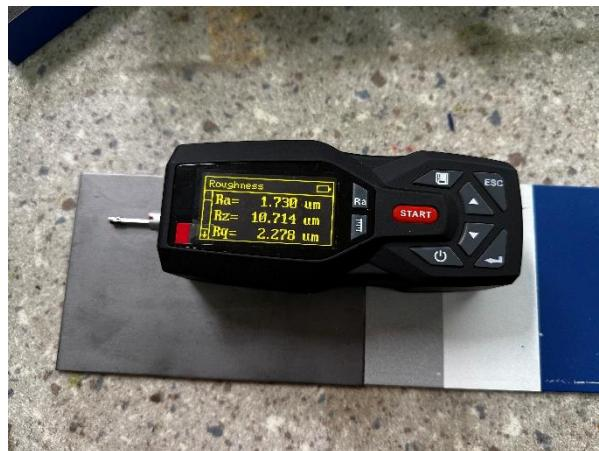
Slika 20. Mjerenje hrapavosti ispitnog uzorka
