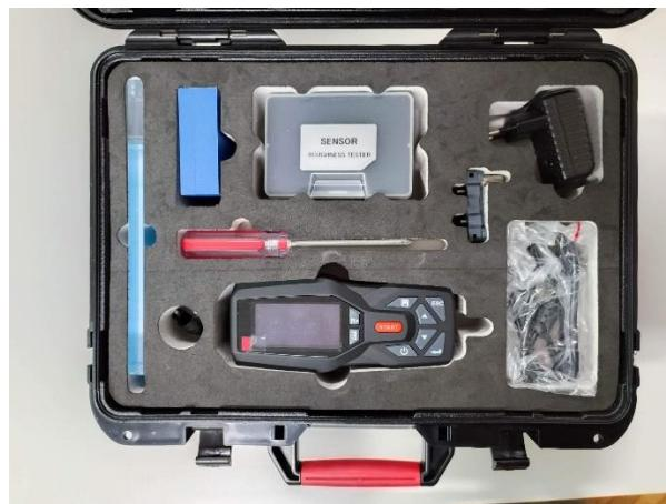
Slika 19. Uređaj za mjerenje hrapavosti površine
