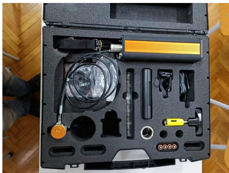
**Slika 29. Set za ispitivanje prionjivosti vlačnom metodom, Elcometer 510 Motel T**
