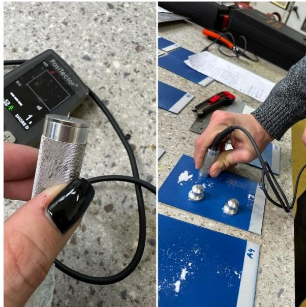
Slika 33. Mjerenje tvrdoće
