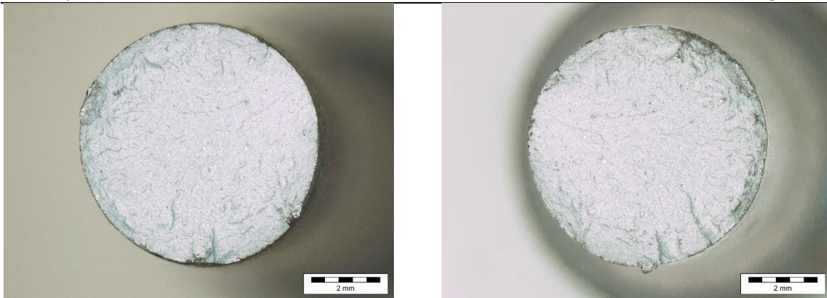
Slika 56 Prijelom SLM T6 toplinski obrađene epruvete 2
