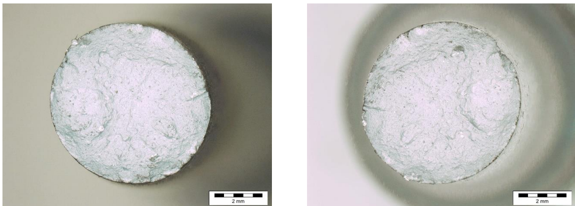
Slika 57 Prijelom SLM EOS T6 toplinski obrađene epruvete 2
