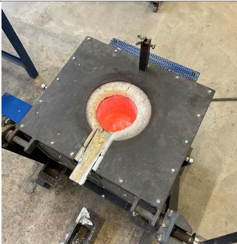
Slika 37 Taljenje aluminijske legure u peći
