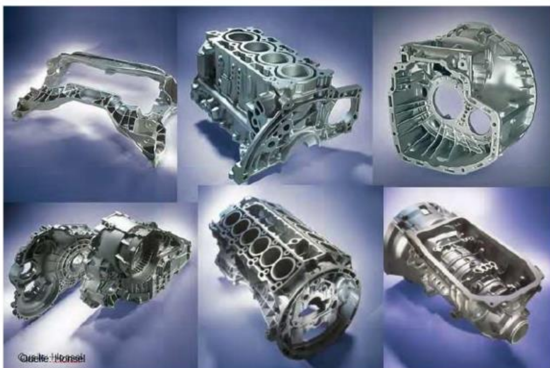
Slika 10 Odljevci od aluminijskih legura rađeni tlačnim lijevanjem [4]
