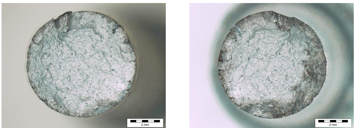
Slika 55 Prijelom SLM toplinski neobrađene epruvete 1
