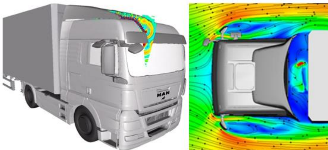
Slika 105. Strujanje zraka te raspodjela tlaka [38]
