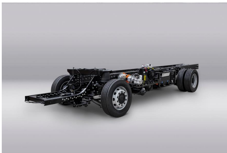
Slika 2. Čelična šasija Volta Zero električnog kamiona [3]
