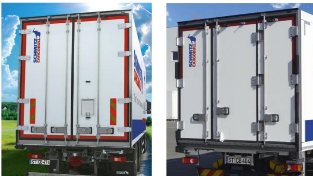
Slika 35. Dvokrilna stražnja vrata (lijevo), trokrilna stražnja vrata (desno) [22]
