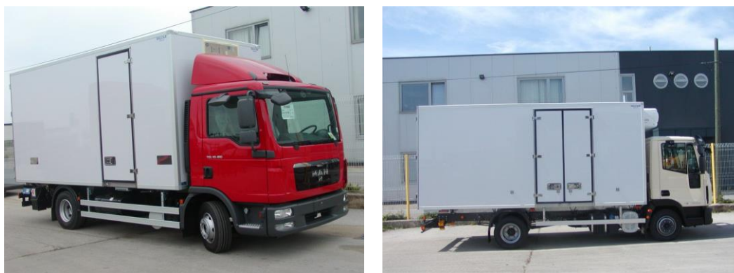
Slika 36. Jednokrilna bočna vrata (lijevo), dvokrilna bočna vrata (desno) [23]
