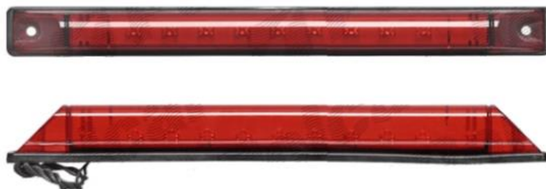
Slika 112. Treće kočno svjetlo proizvođača Polcar [41]
