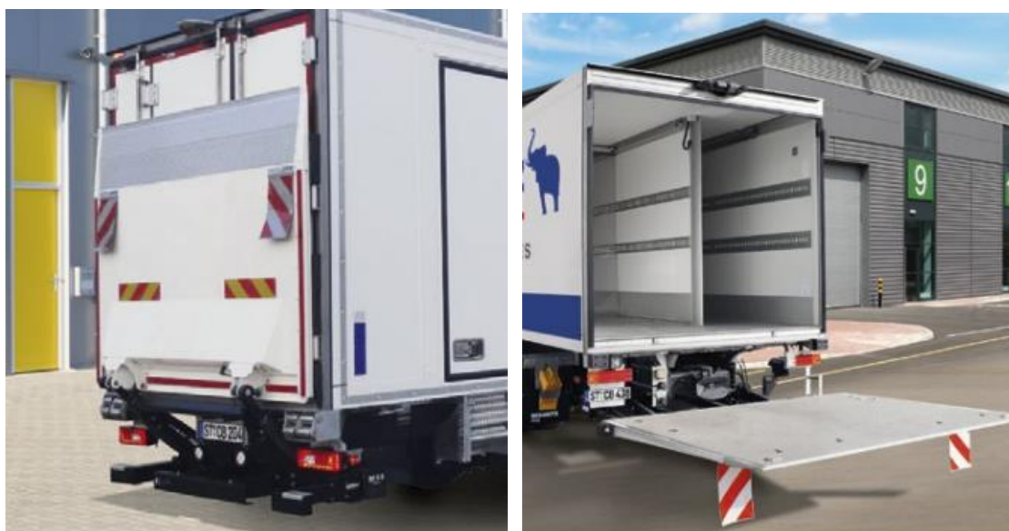
Slika 40. Stražnja naslonjena utovarna platforma (lijevo), stražnja utovarna platforma (desno) [22]
