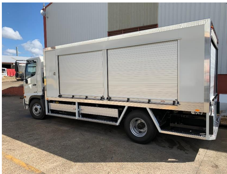
Slika 38. Stražnja rolo vrata [18], bočna rolo vrata [22]
