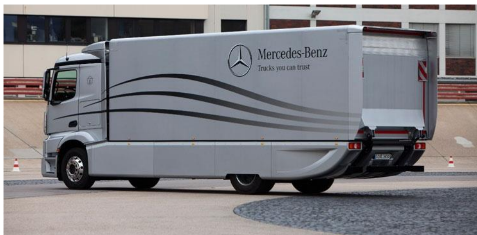
Slika 109. Mercedes-Benz vozilo s aerodinamički zatvorenim prostorom između osovina [38]
