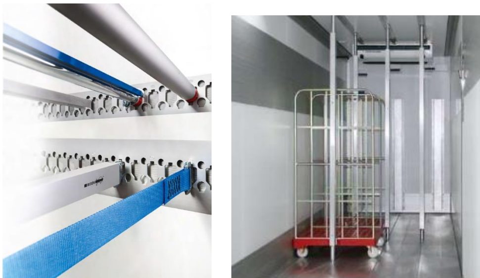
Slika 45. Vertikalno i horizontalno učvršćivanje tereta [20]
