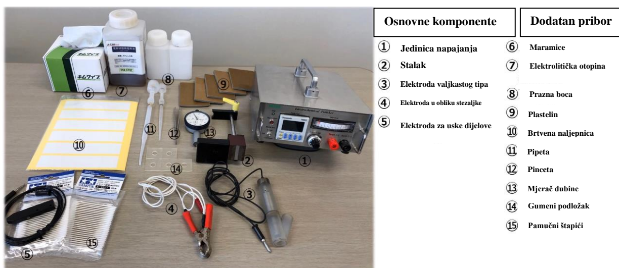
Slika 42. Prikaz stroja za elektrokemijsko poliranje sa svim nastavcima [18]
