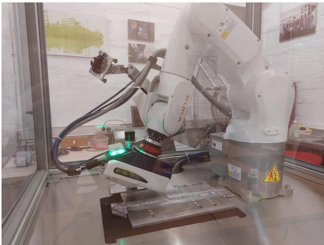
Slika 44. Pulstec \mu -X360s sa robotskom rukom marke Kuka
