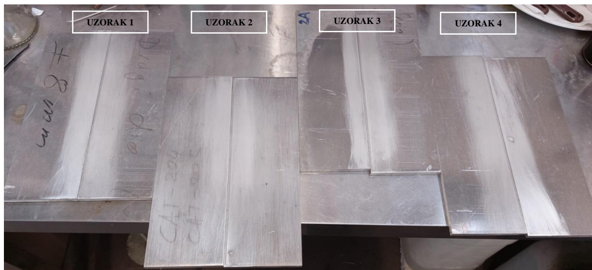
Slika 34. Prikaz Al-Mg ploča prije zavarivanja
