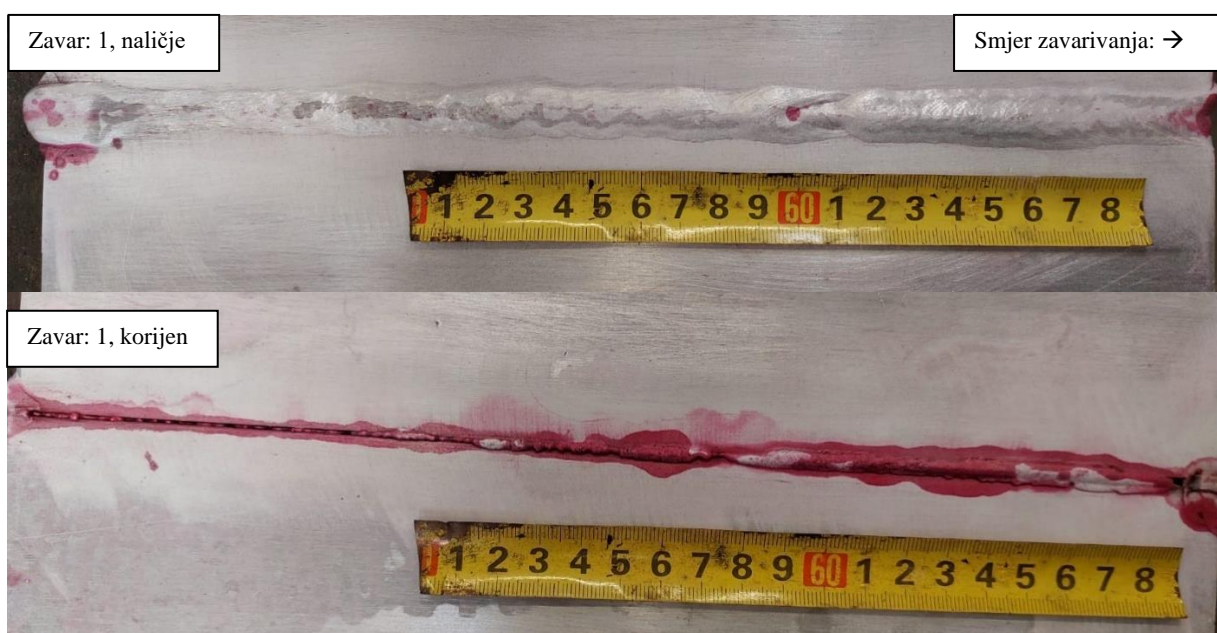
Slika 38. Rezultat ispitivanja penetrantima, uzorak 1
