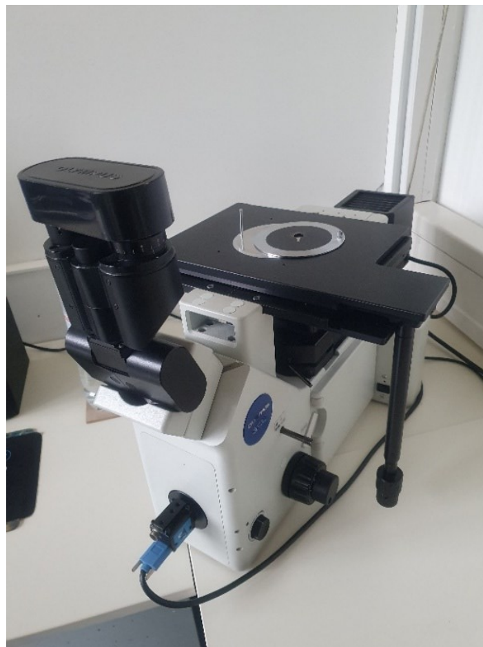
Slika 19. Svjetlosni mikroskop Olympus GX51
