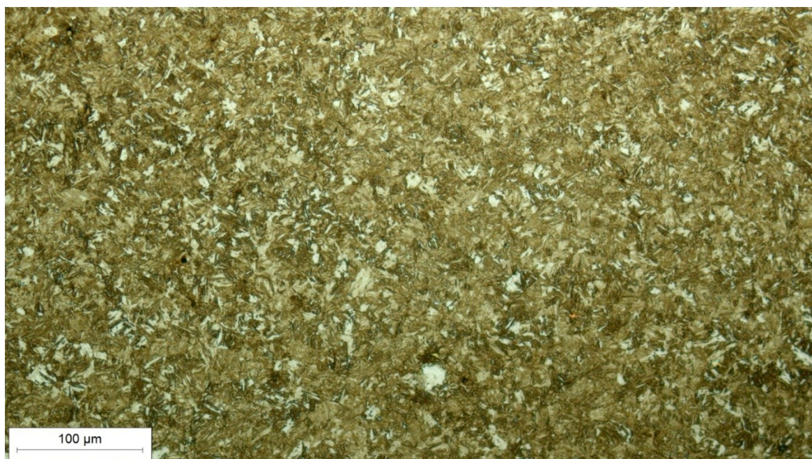
Slika 25. Mikrostruktura čelika XAR 450, snimljeno pri povećanju od 200×
