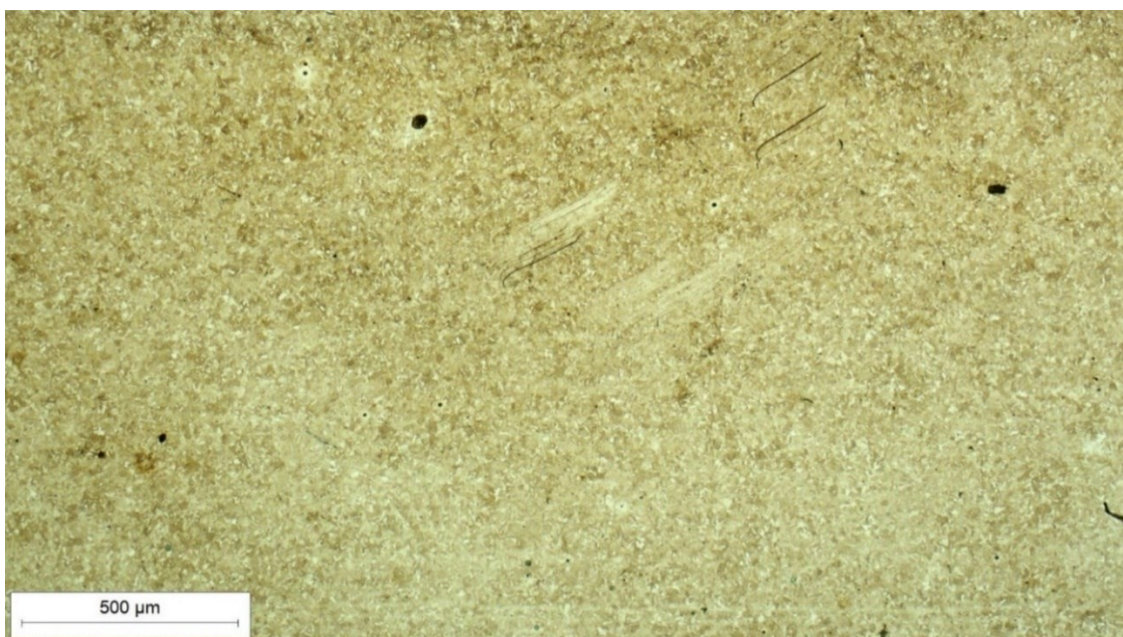
Slika 20. Mikrostruktura čelika Hardox 450, snimljeno pri povećanju od 50×
