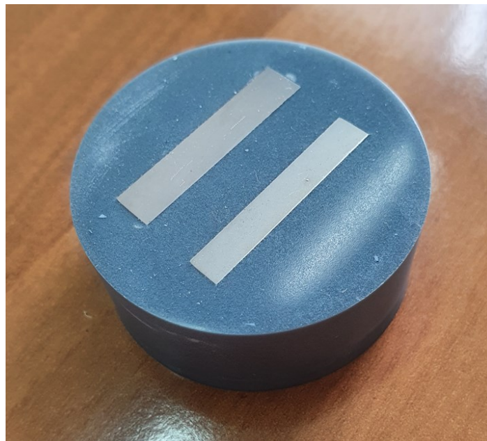
Slika 18. Uzorci u nagriženom stanju
