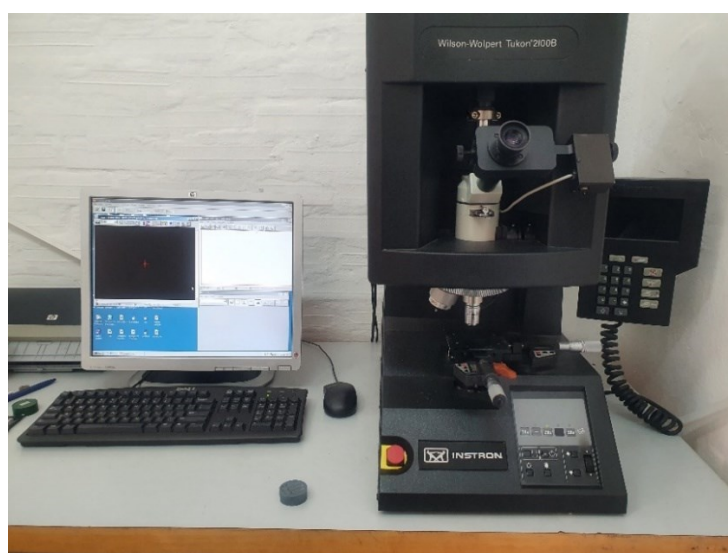
Slika 30. Tvrdomjer Tukon 2100B Wilson-Wolpert
