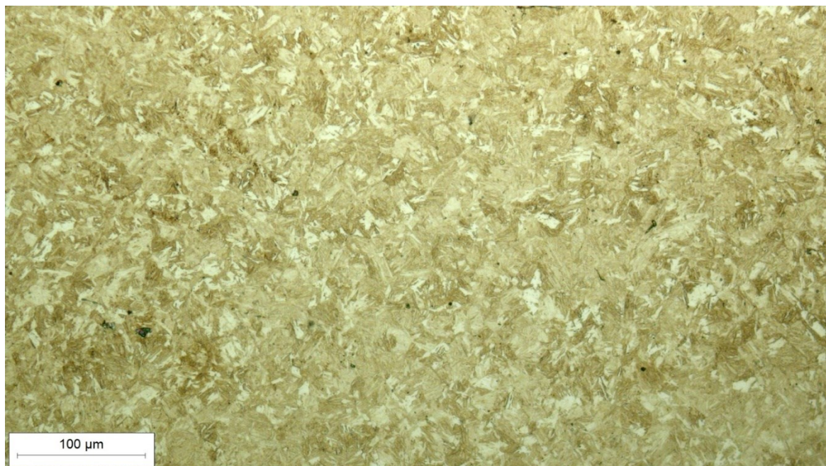
Slika 24. Mikrostruktura čelika Hardox 450, snimljeno pri povećanju od 200×
