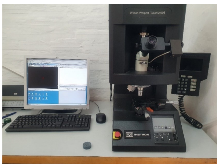
Slika 30. Tvrdomjer Tukon 2100B Wilson-Wolpert
