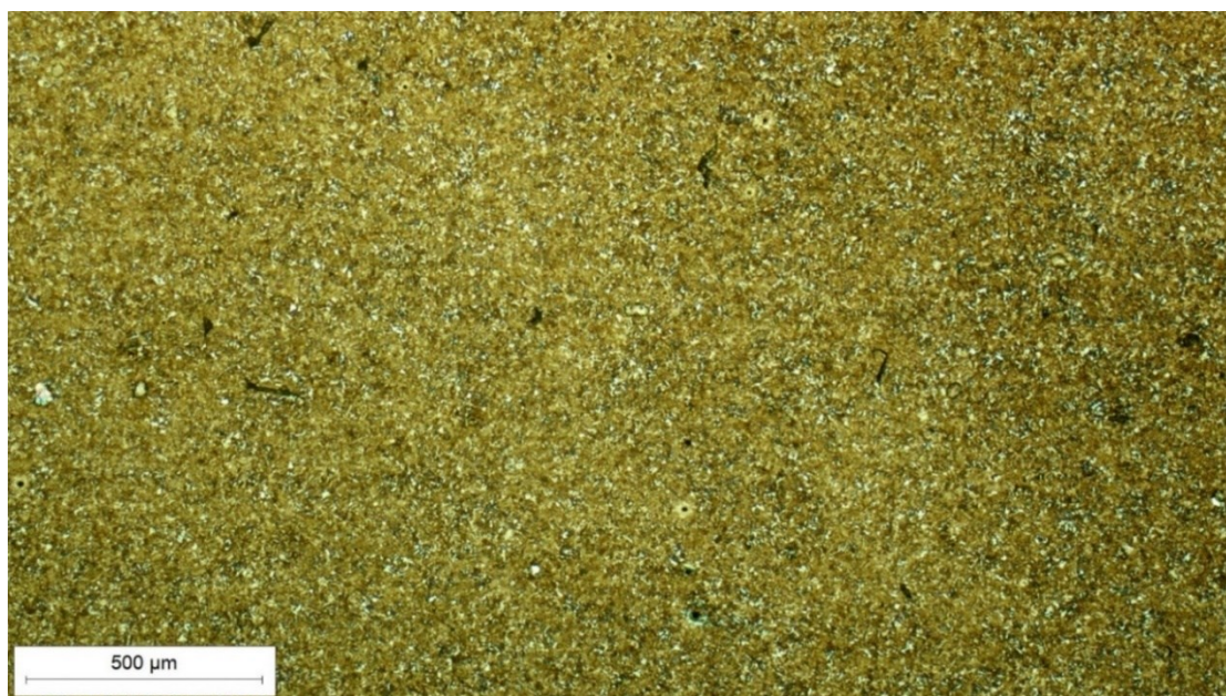
Slika 21. Mikrostruktura čelika XAR 450, snimljeno pri povećanju od 50×
