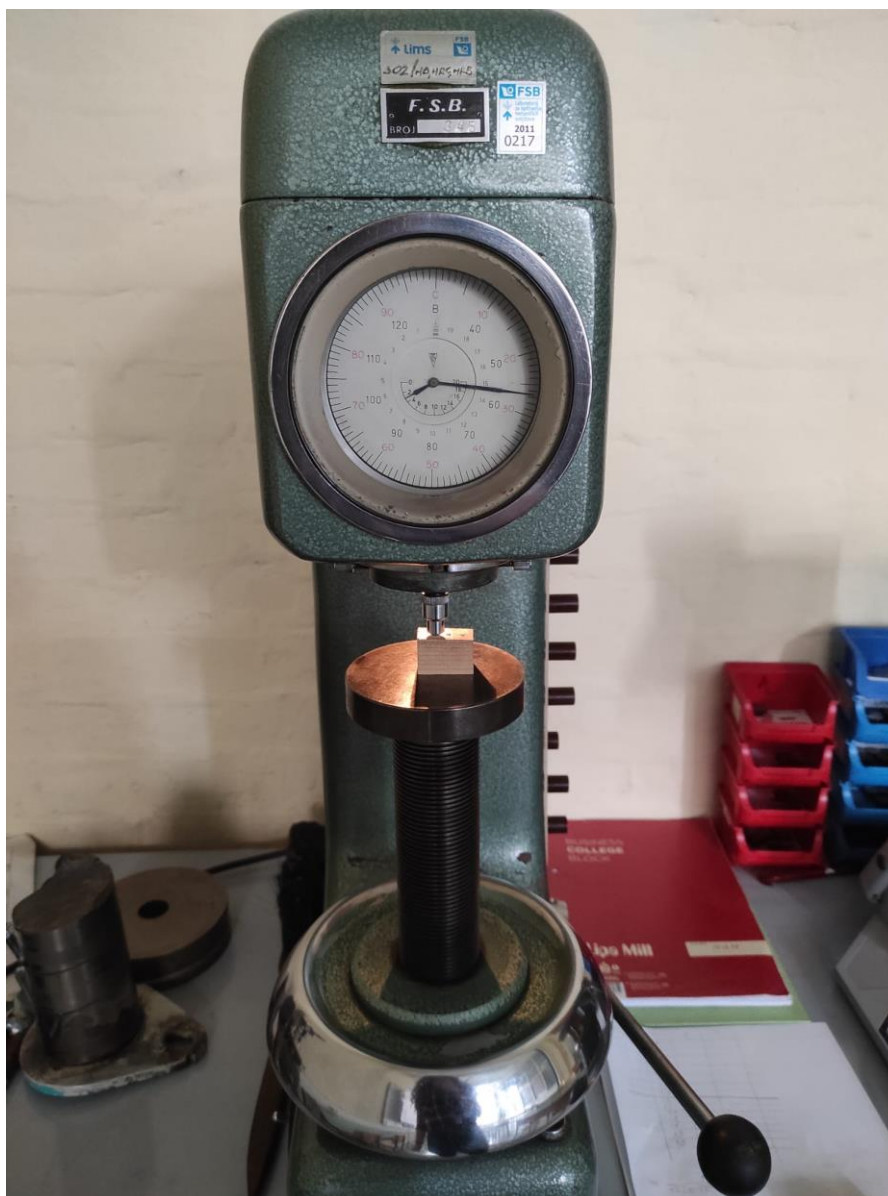
Slika 5.12 Uređaj za ispitivanje tvrdoće metodom po Brinellu
