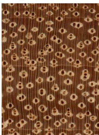
Slika 2.8 Prstenasto porozne, difuzno ili rastresito porozne i semi-difuzno porozne listače [11]
