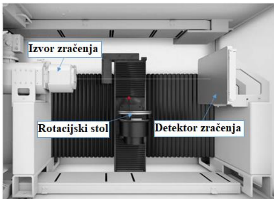
Slika 5.11 Dijelovi CT uređaja [35]
