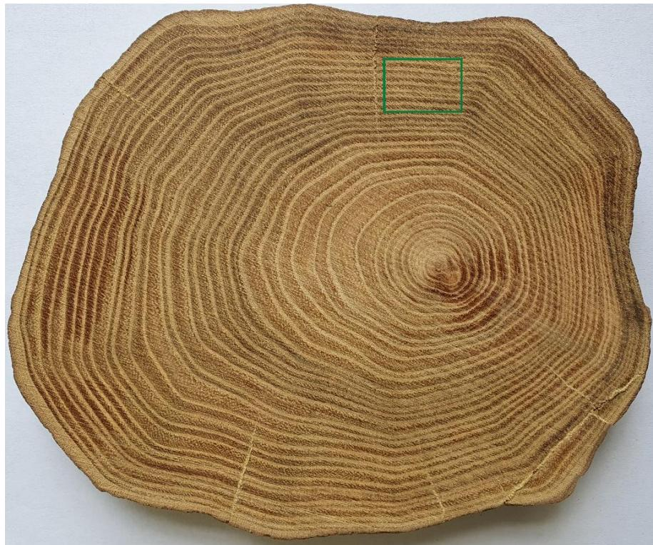
Slika 5.2 Poprečni presjek bagrema i točna pozicija rezanja uzorka
