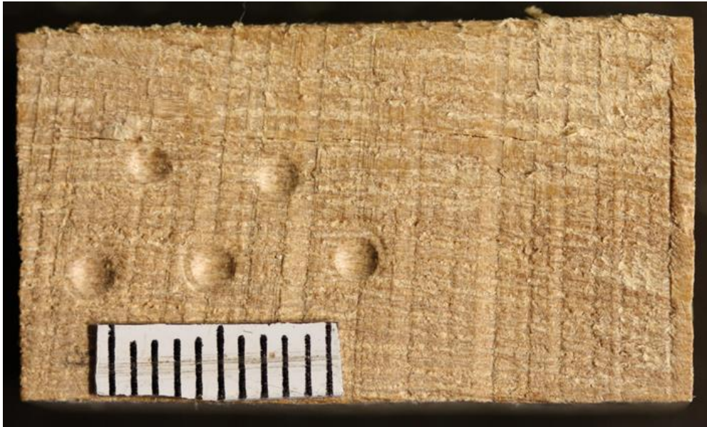
Slika 5.13 Otisci kuglice pri mjenju tvrdoće na tangencijalnom presjeku
