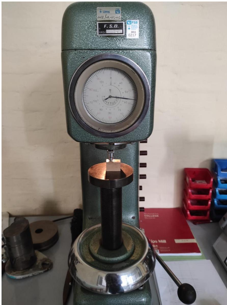
Slika 5.12 Uređaj za ispitivanje tvrdoće metodom po Brinellu
