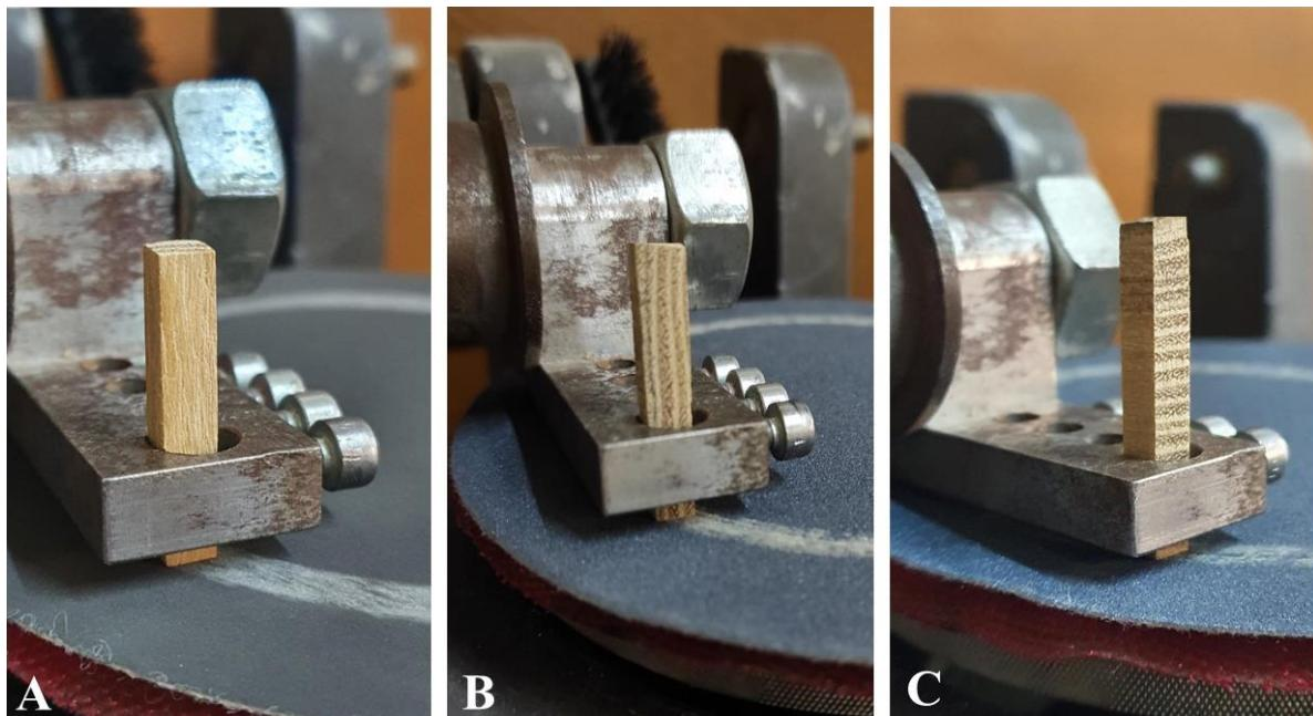
**Slika 5.10 Ispitivanje otpornosti abrazijskog trošenja na uredaju Taber abrader A - poprečnog, B - radijalnog i C - tangencijalnog presjeka**
