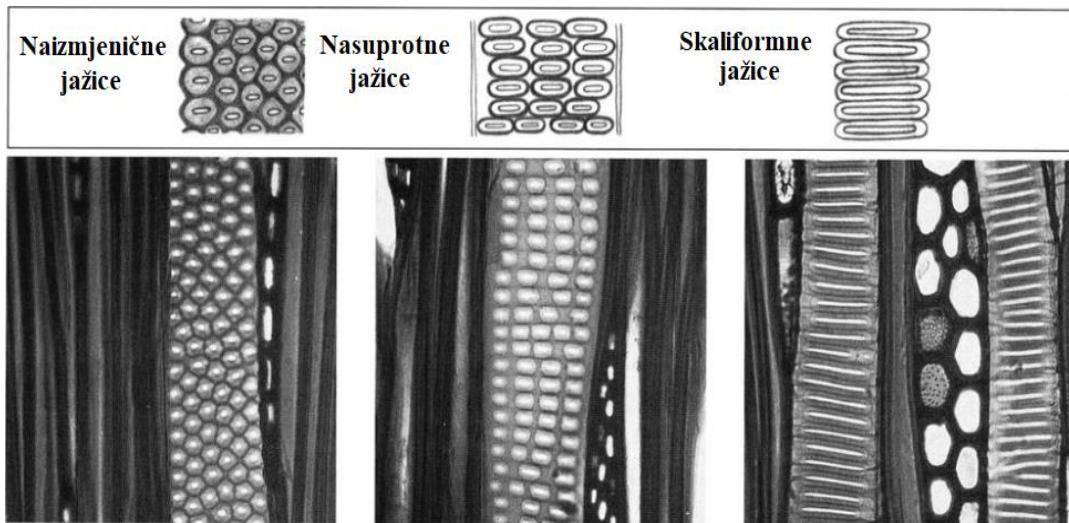
Slika 2.22 Prikaz naizmjeničnih, nasuprotnih i skaliformnih jažica [17]
