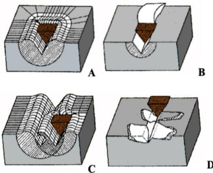
**Slika 3.4 Mehanizmi abrazijskog trošenja A – mikroabrazija, B – mikrorezanje, C – mikroumor, D – mikronaprsnuća [22]**
