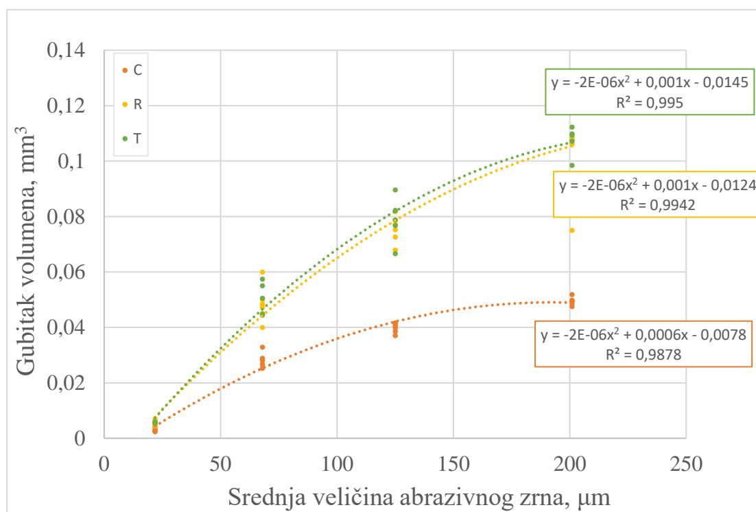
Slika 5.18 Gubitak volumena svih presjeka pri abrazijskom trošenju
