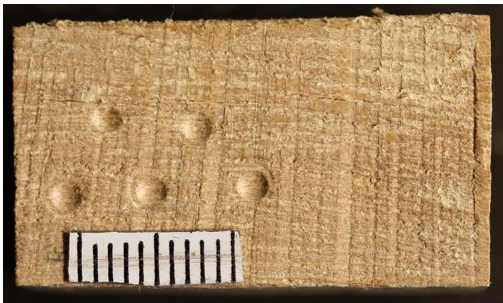
**Slika 5.13 Otisci kuglice pri mjerenu tvrdoće na tangencijalnom presjeku**
