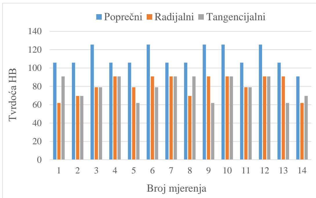
Slika 5.20 Rezultati mjerjenja tvrdoće na karakterističnim presjecima
