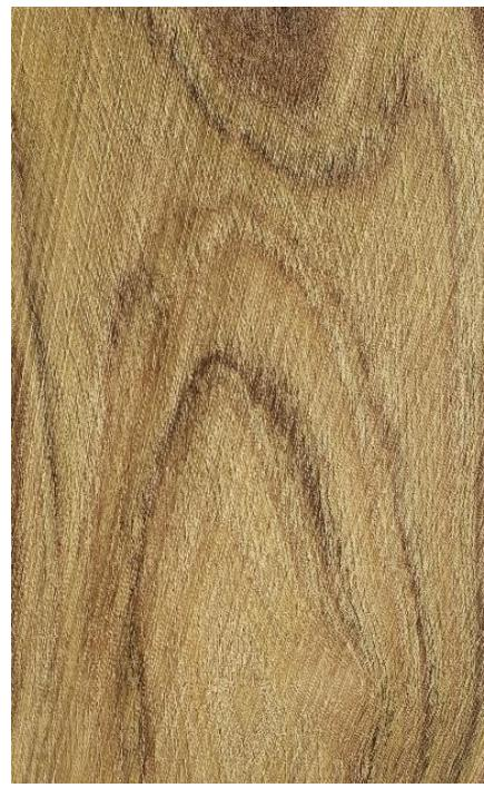
Slika 5.4 Tangencijalni presjek
