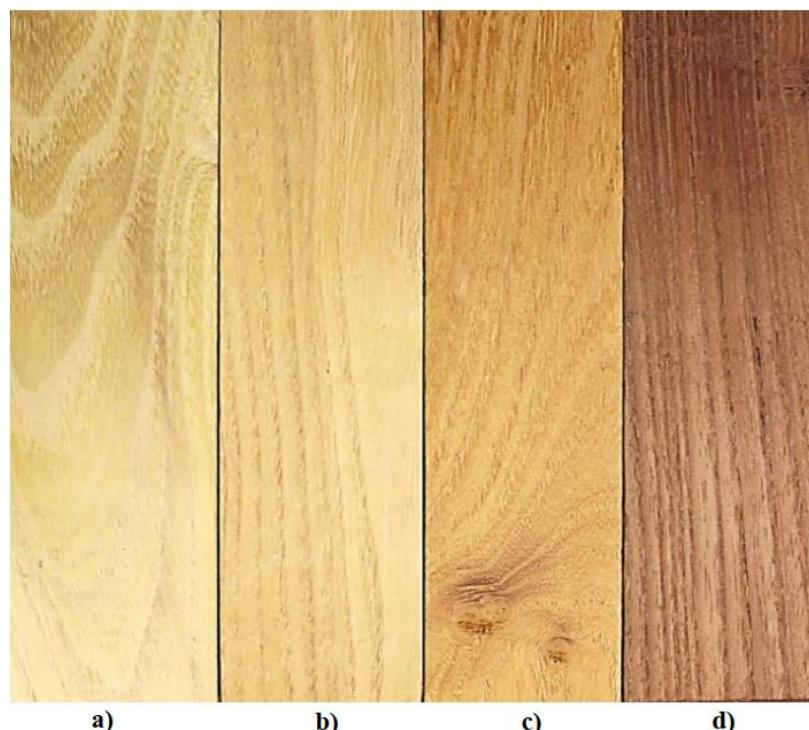
**Slika 4.5 Tekstura drva bagrema prije i nakon toplinske obrade pri različitim parametrima a) prirodna boja, b) svijetlosmeđa boja,  $t = 5,5 \text{ h}$ ,  $T = 110^{\circ}\text{C}$ , c) sivkasto - smeđa boja,  $t = 6,5 \text{ h}$ ,  $T = 125^{\circ}\text{C}$  d) sivo - smeđa boja,  $t = 7,5 \text{ h}$ ,  $T = 135^{\circ}\text{C}$  [32]**
