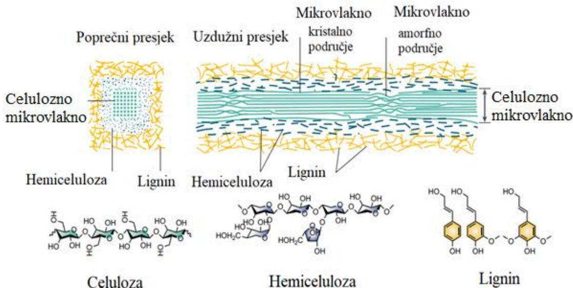
Slika 2.2 Poprečni i uzdužni presjek pojedinačnog mikrovlakna [1]
