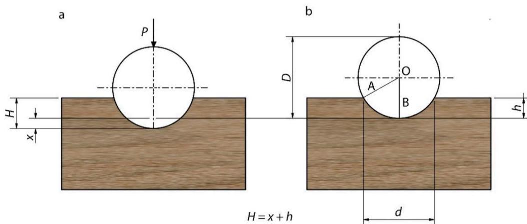
**Slika 3.3 Metoda određivanje tvrdoće drva po Brinellu: a) kuglica pod opterećenjem, b) kuglica nakon uklanjanja opterećenja (P – opterećenje, D – promjer kuglice, d – promjer otiska, H – ukupna dubina prodiranja, h – trajni prodor, x – privremeni prodor) [20]**
