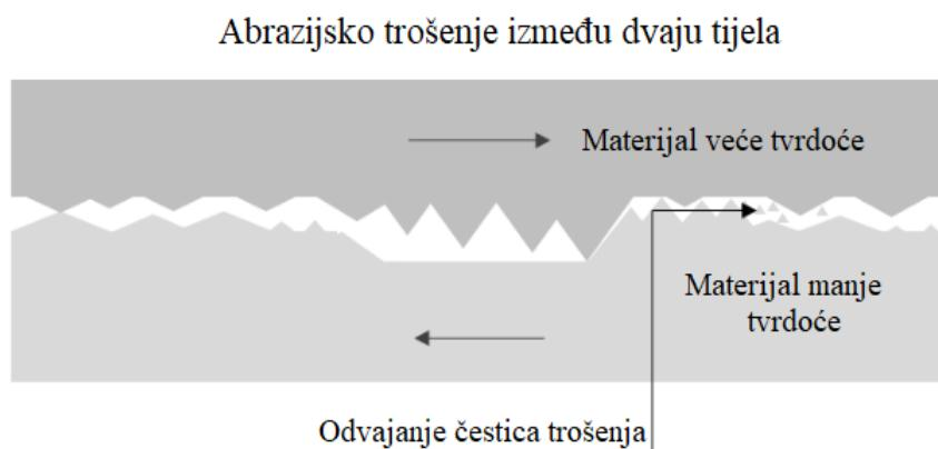
Slika 3.6 Shematski prikaz abrazijskog trošenja između dvaju tijela [24]
