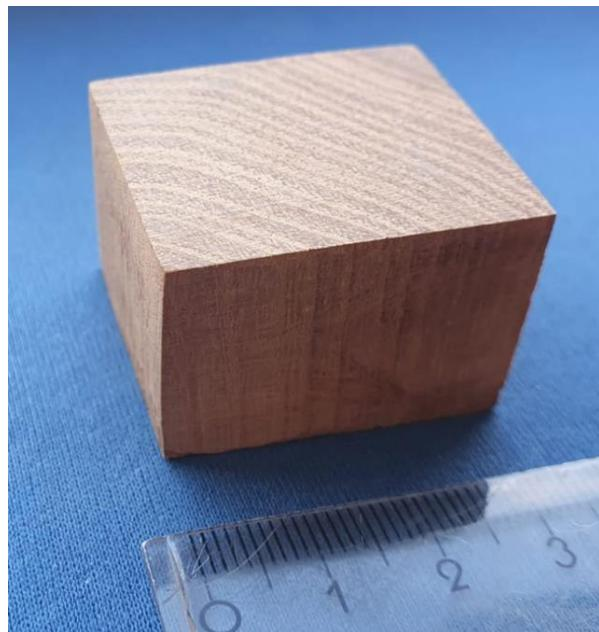
**Slika 5.8 Uzorak za određivanje gustoće i udjela vlage**
