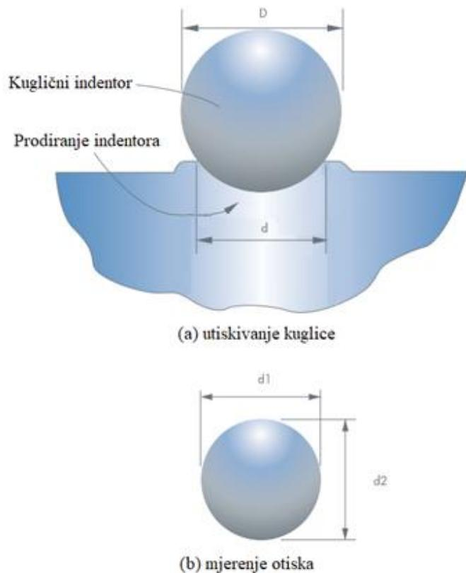
Slika 3.2 Shematski prikaz mjerjenja tvrdoće metodom po Brinellu [21]
