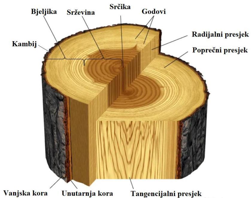
**Slika 2.6 Slojevi drvnog tkiva vidljivi u poprečnom presjeku [8]**
