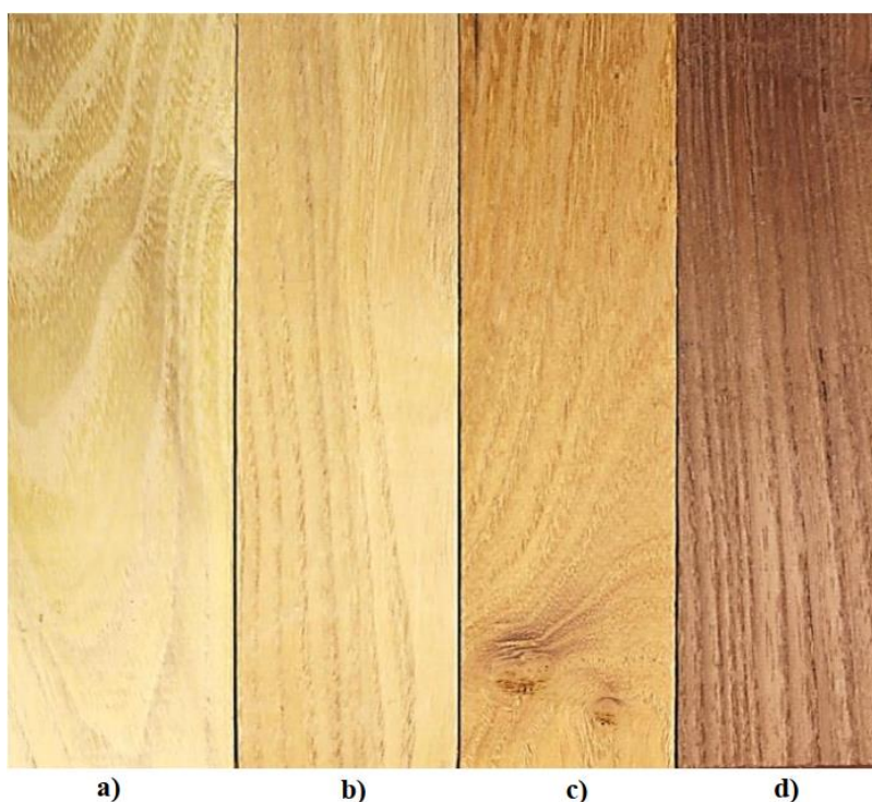
Slika 4.5 Tekstura drva bagrema prije i nakon toplinske obrade pri različitim parametrima a) prirodna boja, b) svijetlosmeđa boja, t = 5,5 h, T = 110 °C, c) sivkasto - smeđa boja, t = 6,5 h, T = 125 °C d) sivo - smeđa boja, t = 7,5 h, T = 135 °C [32]
