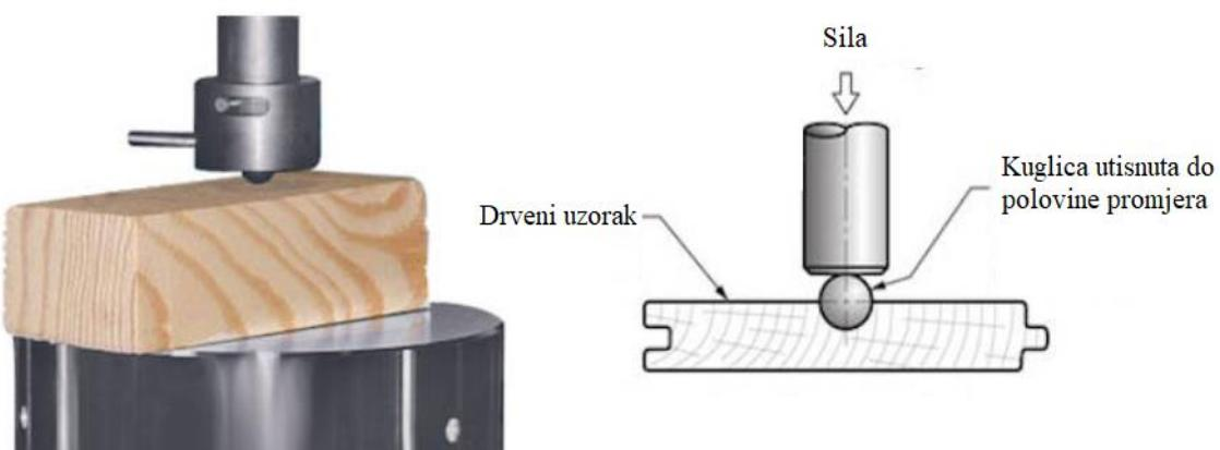
Slika 3.1 Shema ispitivanja tvrdoće prema Janki metodi [19]
