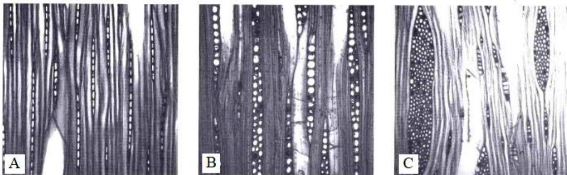
Slika 2.23 Prikaz drvnih traka listača A - jednoredni, B - dvoredni, C - višerednidrvni traci [18]
