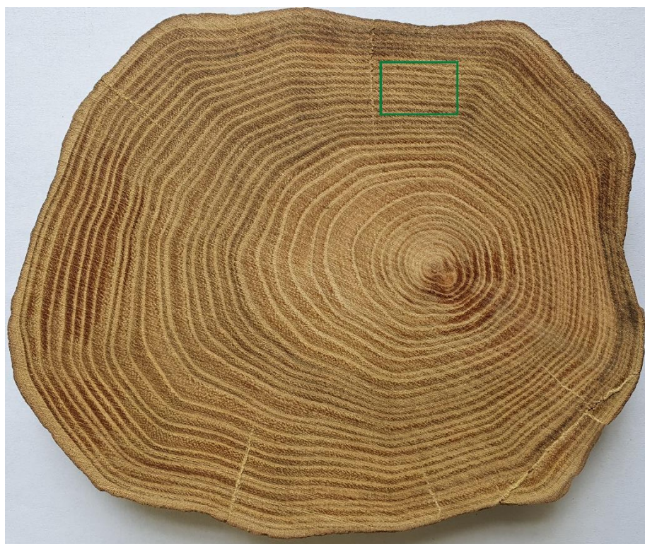
Slika 5.2 Poprečni presjek bagrema i točna pozicija rezanja uzoraka
