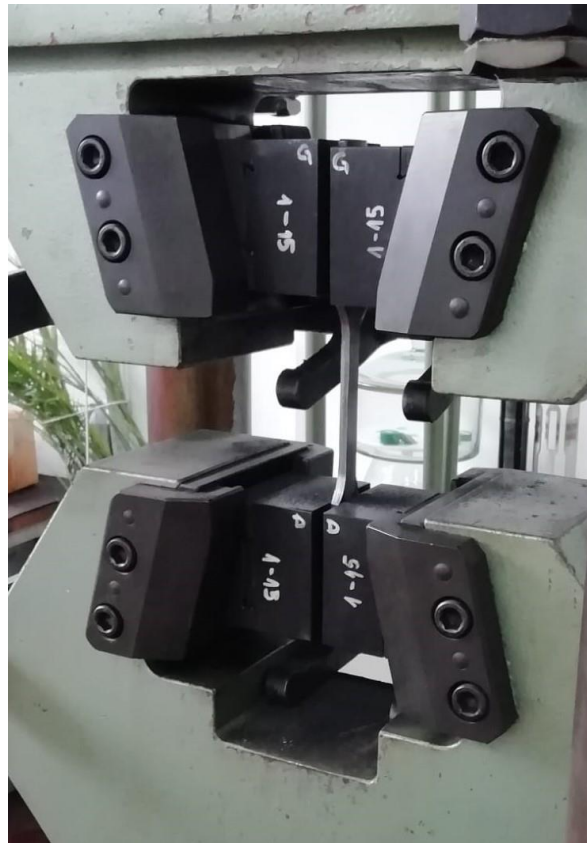
Slika 8.19 Ispitni uzorak postavljen u čeljust kidalice
