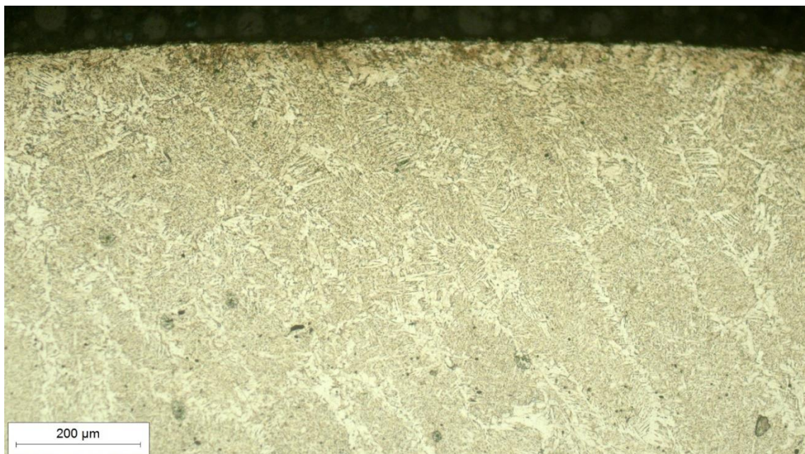
Slika 8.30 Mikrostruktura tjemena zavara, snimljena pri povećanju 100×
