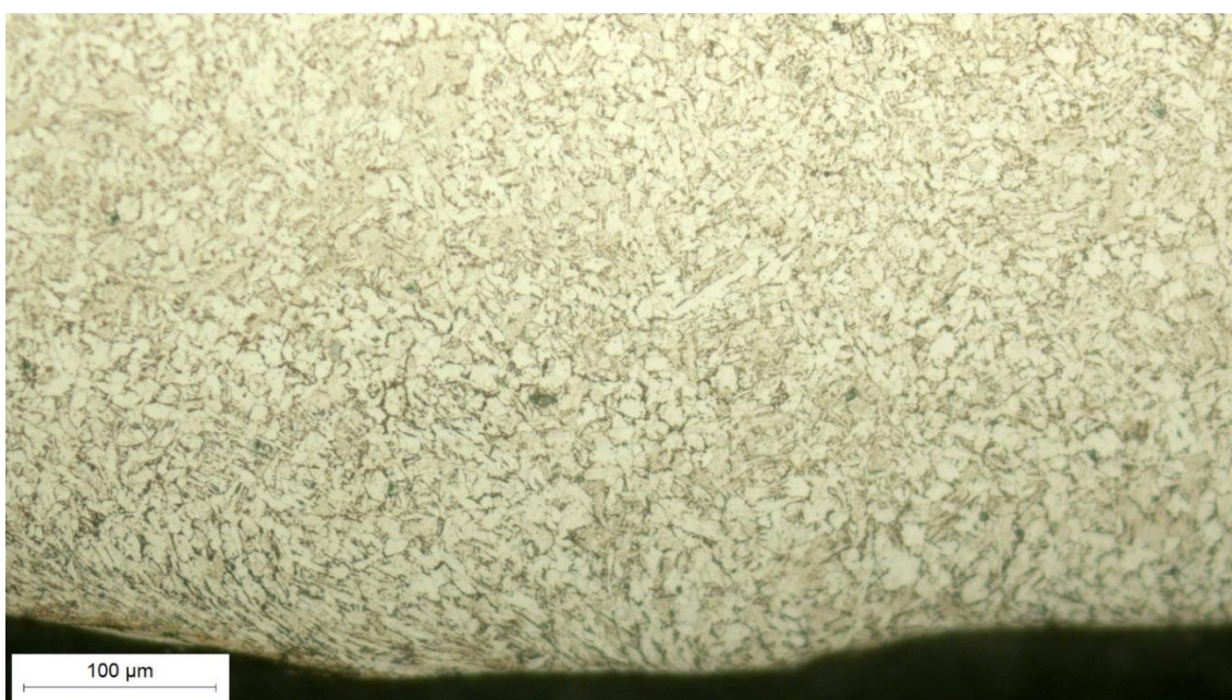
Slika 8.34 Mikrostruktura korijena zavara, snimljena pri povećanju 200×
