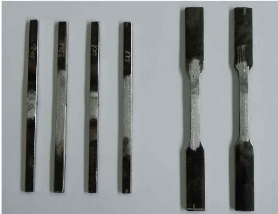
Slika 8.2 Izgled ispitnih uzoraka za ispitivanje savijanjem i za statičko vlačno ispitivanje
