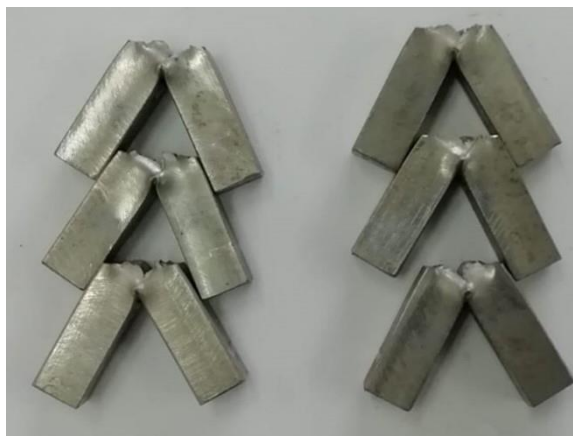
Slika 8.23 Ispitni uzorci nakon provedenog ispitivanja žilavosti
