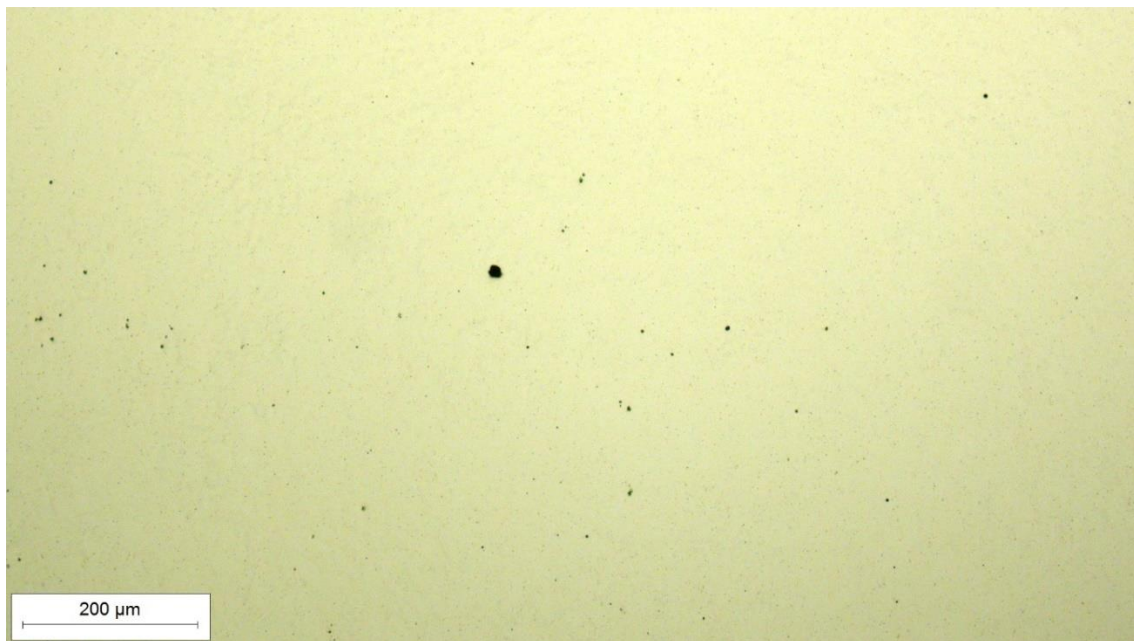
Slika 8.25 Mikrostruktura metala zavara u poliranom stanju, snimljena pri povećanju 100×
