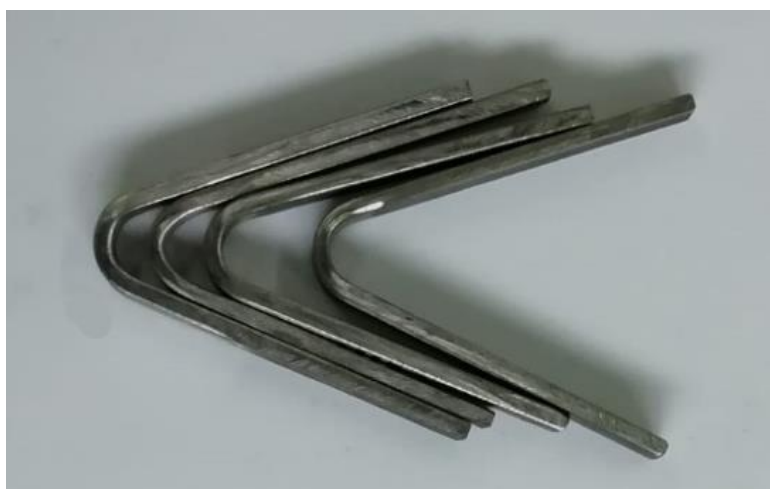
Slika 8.41 Izgled ispitnih uzoraka nakon savijanja
