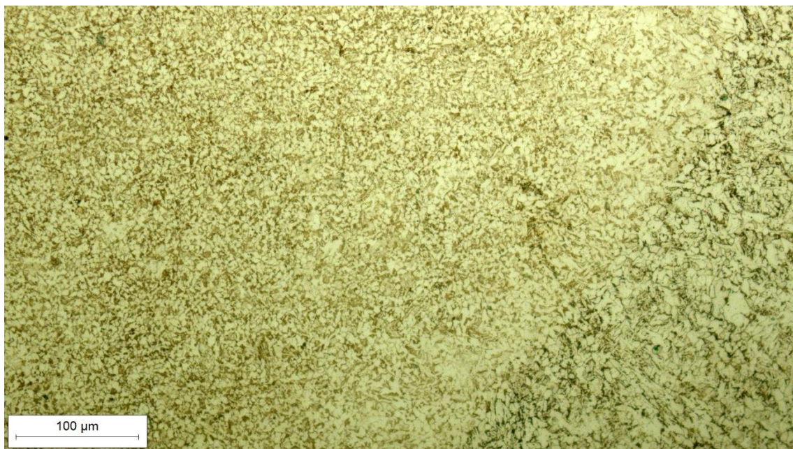
Slika 8.40 Mikrostruktura ZUT-a s lijeve strane korijena zavara, snimljena pri povećanju 200×
