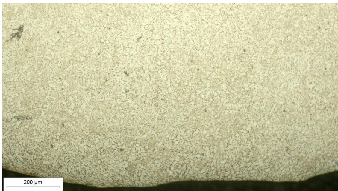
Slika 8.33 Mikrostruktura korijena zavara, snimljena pri povećanju 100×
