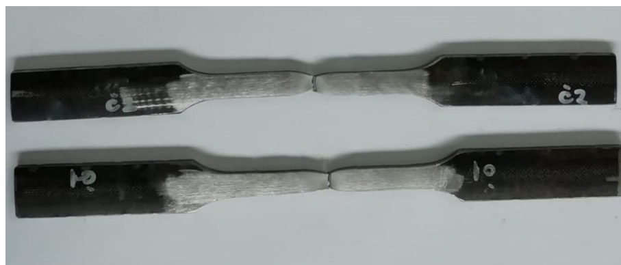
Slika 8.20 Izgled ispitnih uzoraka nakon ispitivanja vlačne čvrstoće
