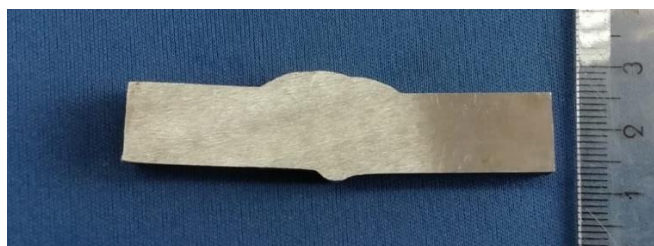
Slika 8.7 Uzorak za analizu makrostrukture
