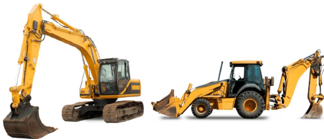
Slika 4.1 Bager gusjeničar (lijevo) i bager kombinirka (desno)[16]
