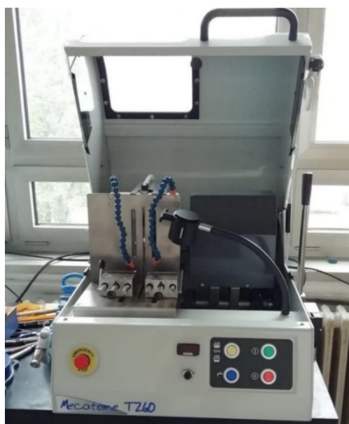
Slika 8.8 Rezalica Presi Mecatome T260
