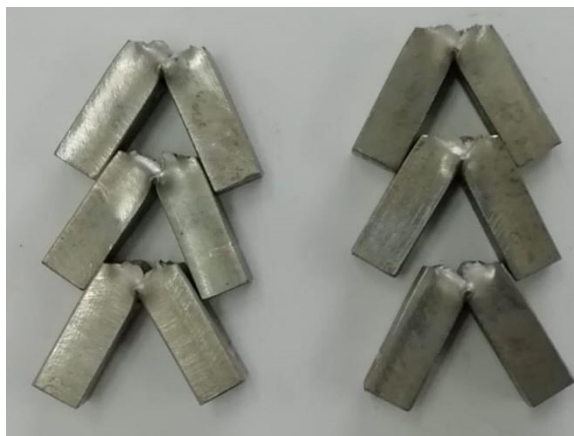
Slika 8.23 Ispitni uzorci nakon provedenog ispitivanja žilavosti
