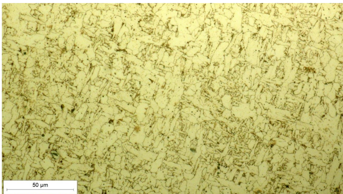
Slika 8.32 Mikrostruktura sredine metala zavara, snimljena pri povećanju 500×
