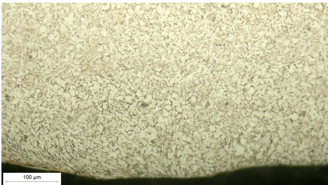
Slika 8.34 Mikrostruktura korijena zavara, snimljena pri povećanju 200×
