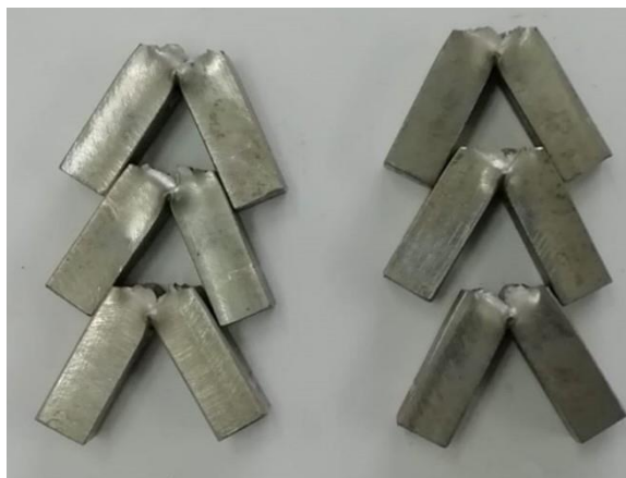
Slika 8.23 Ispitni uzorci nakon provedenog ispitivanja žilavosti
