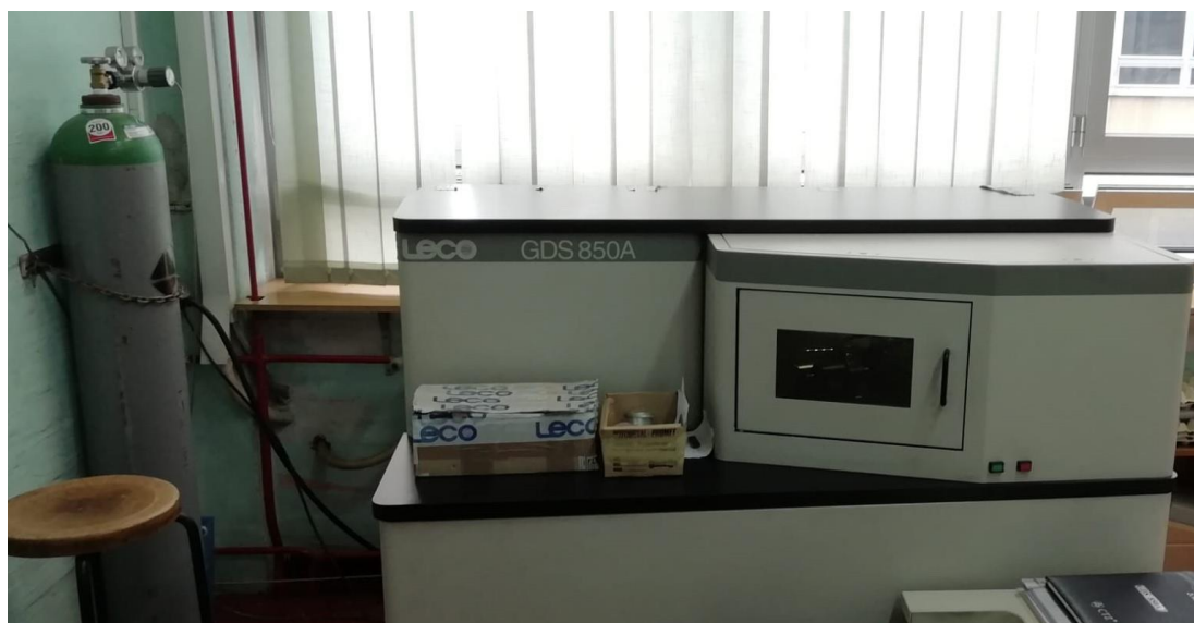
Slika 8.5 Spektrometar LECO GDS 850A
