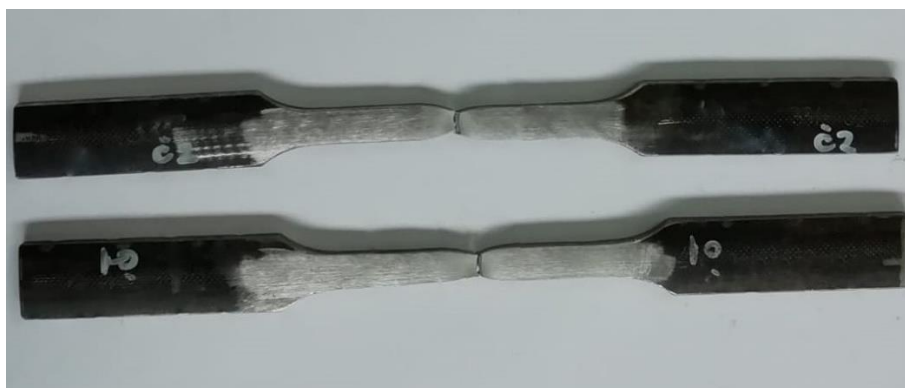
Slika 8.20 Izgled ispitnih uzoraka nakon ispitivanja vlačne čvrstoće
