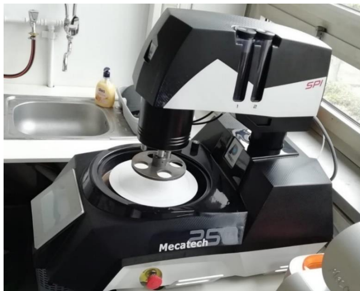
Slika 8.9 Uređaj za brušenje i poliranje Presi Mecatech 250
