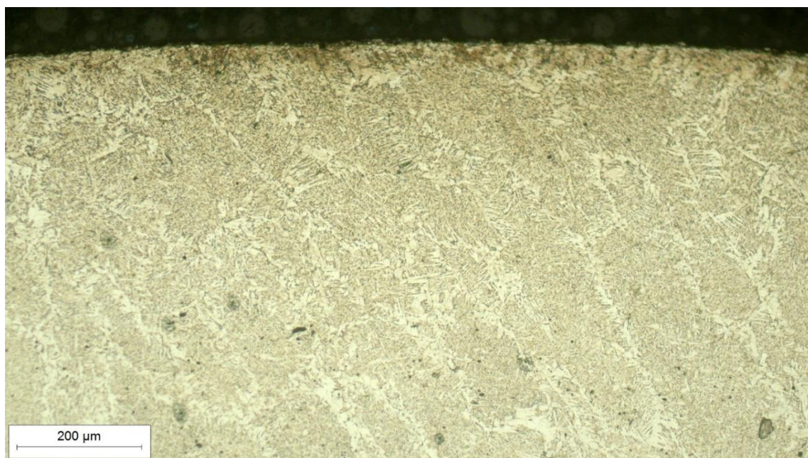
Slika 8.30 Mikrostruktura tjemena zavara, snimljena pri povećanju 100×
