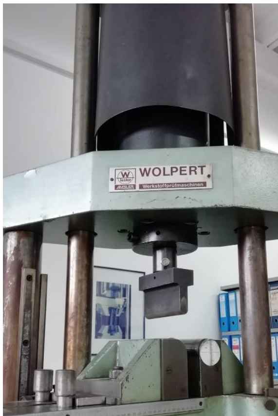
Slika 8.21 Prostor kidalice namijenjen za ispitivanje savijanjem i pritiskom
