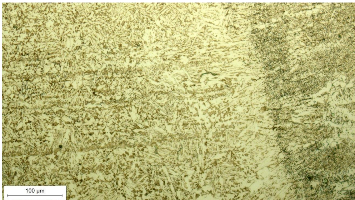
Slika 8.38 Mikrostruktura ZUT-a s lijeve strane sredine metala zavara, snimljena pri povećanju 200×
