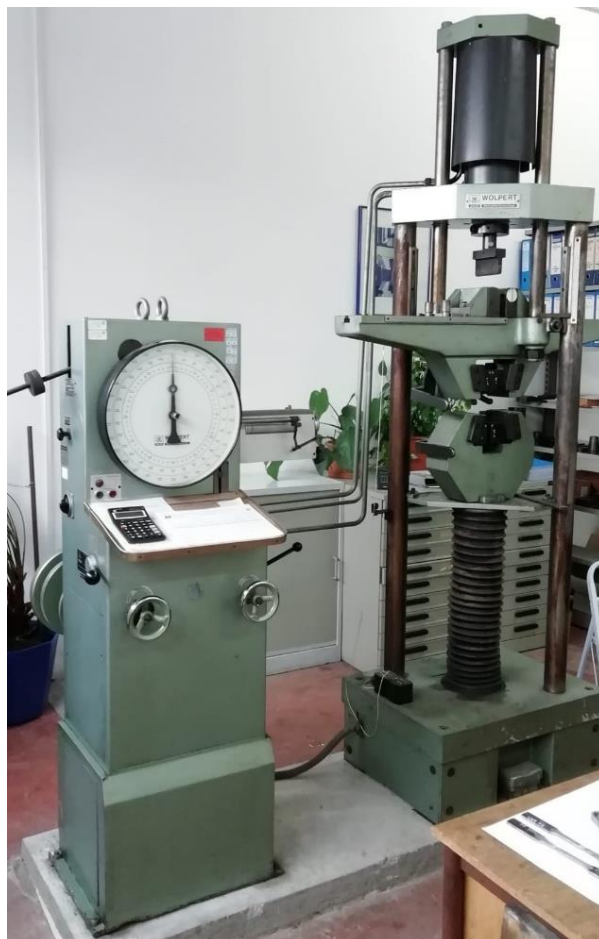
Slika 8.18 Univerzalna kidalica Otto Wolpert Werke GmbH 30 TUZ 757
