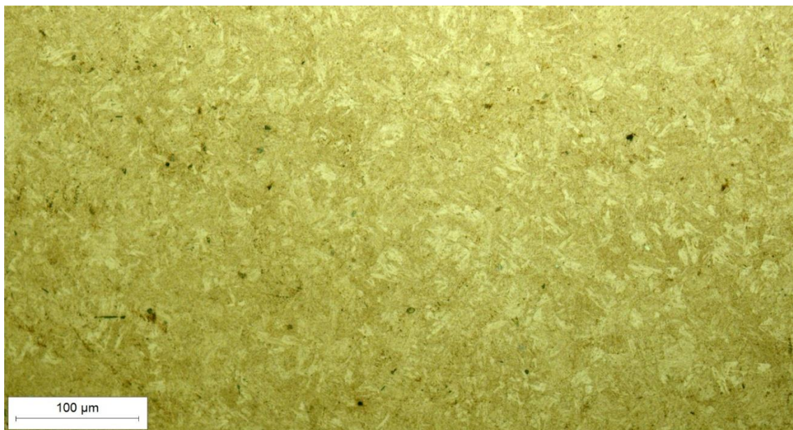
Slika 8.27 Mikrostruktura osnovnog materijala, snimljena pri povećanju 200\times
