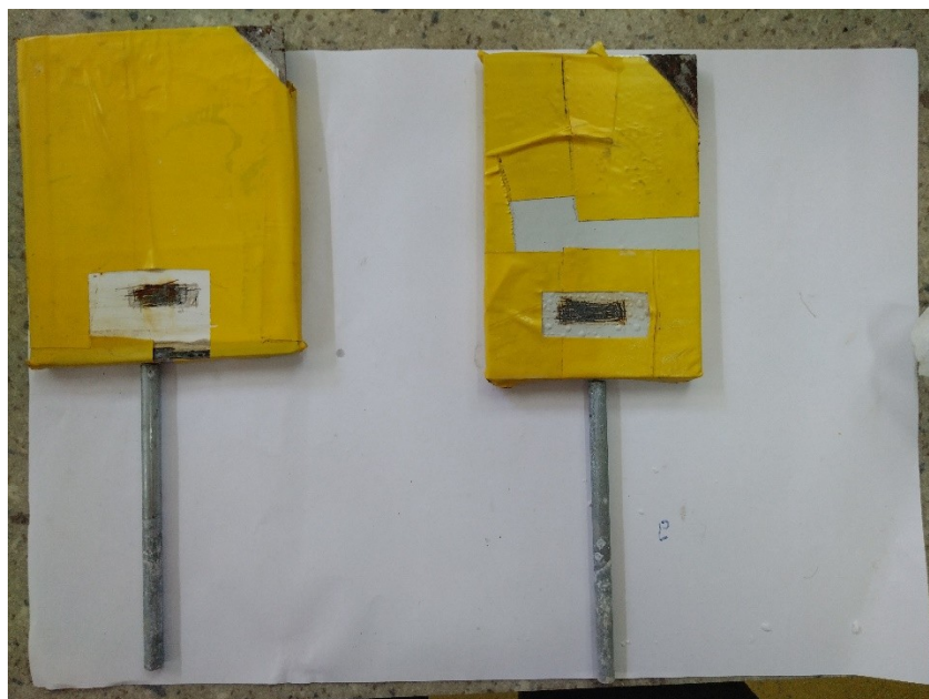
Slika 41. Anode Z1' i Z2' s pripadajućim uzorcima
