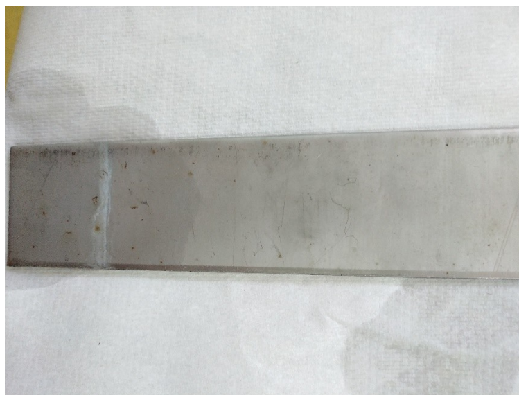
Slika 37. Trajna anoda nehrdajućeg čelika za ispitivanje narintom strujom
