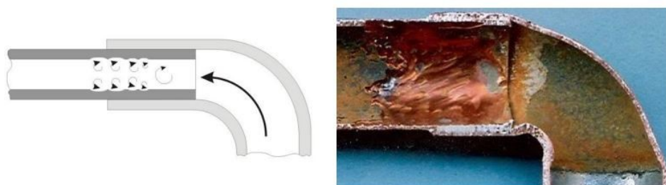
Slika 7. Djelovanje erozijske korozije na materijal [3]
