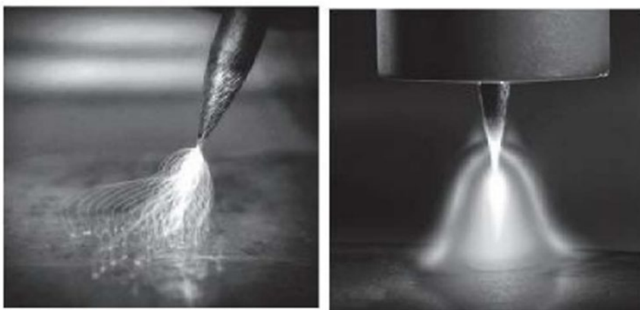
Slika 3 Uspostava električnog luka kod TIG zavarivanja [2]
