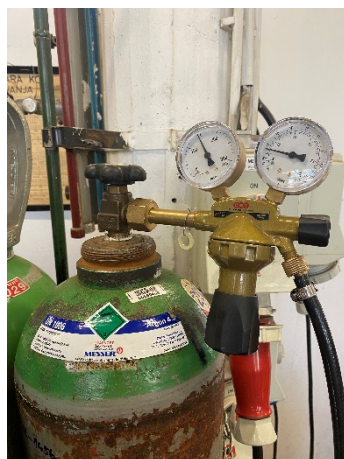
Slika 52 Regulator protoka plina za zaštitu električnog luka
