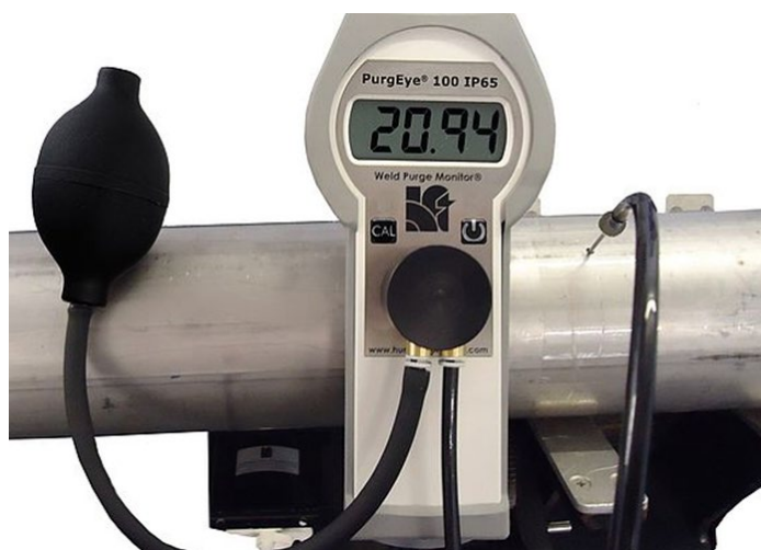
Slika 31 Mjerenje razine kisika u cijevi sa PurgEye 100 [26]
