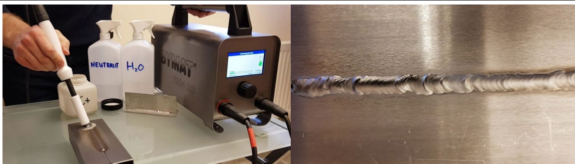
Slika 39 Ručno elektrolitičko čišćenje zavora [35]
