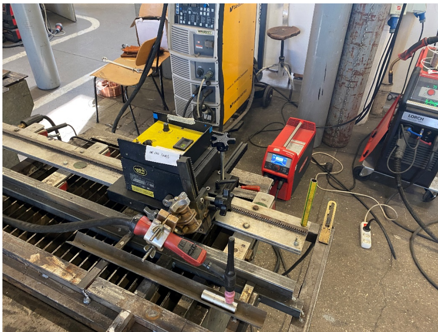
Slika 45 "BUG-O systems" automat za zavarivanje
