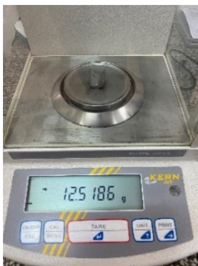
Slika 77 Mjerenje mase uzoraka nakon nagrizanja
