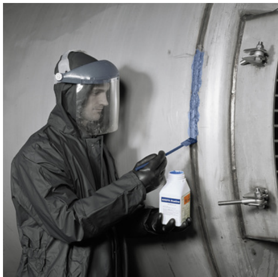
Slika 38 Kemijsko čišćenje zavora nakon zavarivanja s pastom [34]
