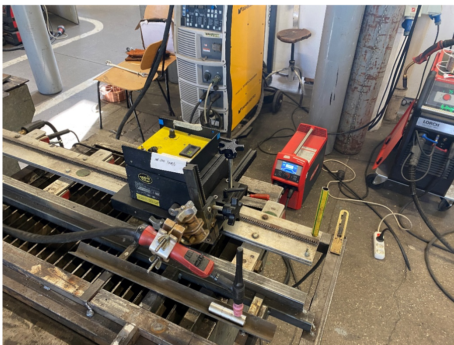
Slika 45 "BUG-O systems" automat za zavarivanje
