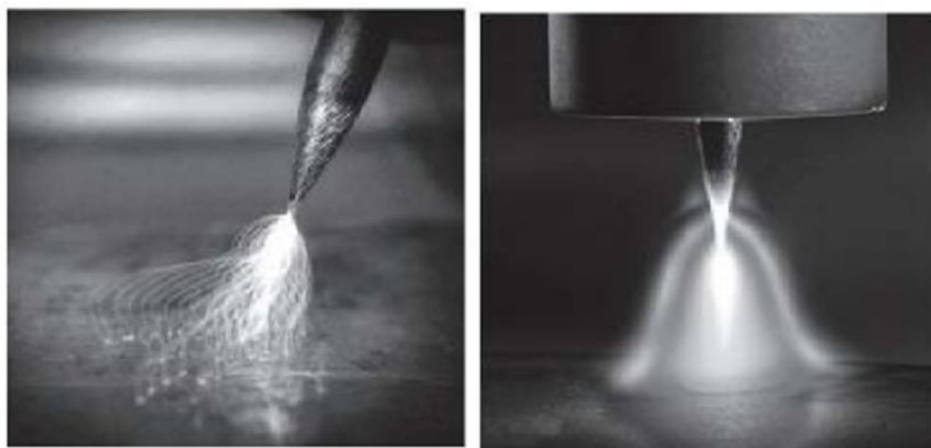
Slika 3 Uspostava električnog luka kod TIG zavarivanja [2]
