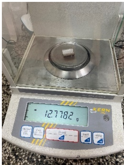
Slika 72 Mjerenje mase uzoraka prije ispitivanja na koroziju
