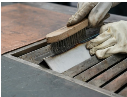
Slika 37 Ručno četkanje zavora nakon TIG zavarivanja [34]
