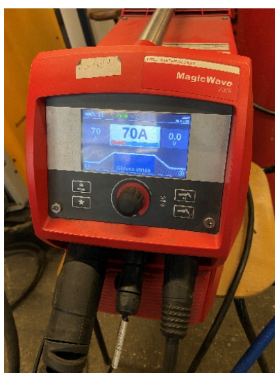
Slika 43 Izvor struje za zavarivanje "MagicWave 230i"
