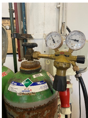
Slika 52 Regulator protoka plina za zaštitu električnog luka
