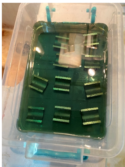
Slika 74 Uzorci nakon 72 h ispitivanja u željezovom kloridu
