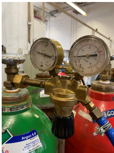
Slika 50 Podešavanje protoka plina za korijensku zaštitu
