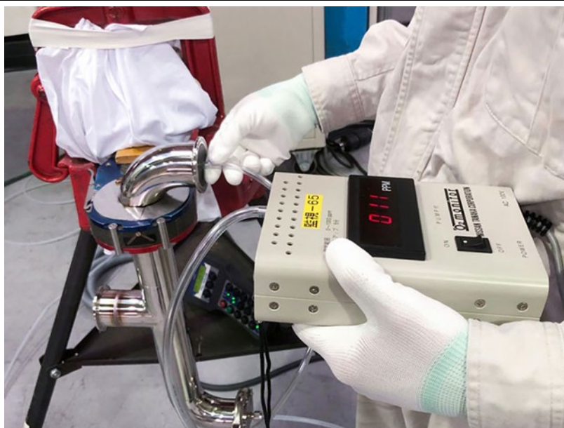
Slika 32 Mjerenje razine kisika u cijevi tijekom orbitalnog TIG zavarivanja [27]
