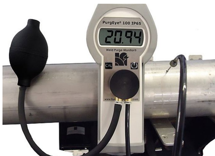
Slika 31 Mjerenje razine kisika u cijevi sa PurgEye 100 [26]
