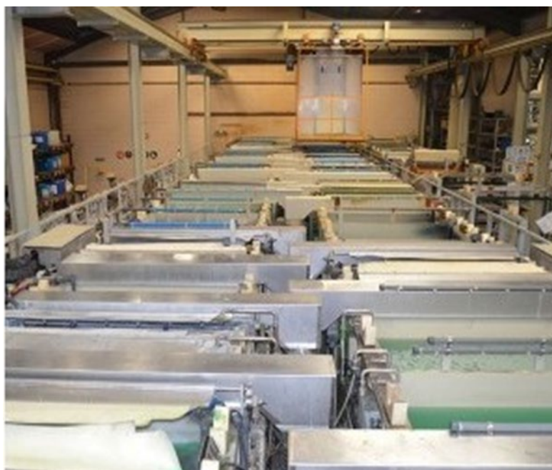
Slika 40 Kupke za elektrolitičko čišćenje [35]
