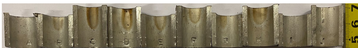
Slika 78 Uzorci za izradu makroizbruska
