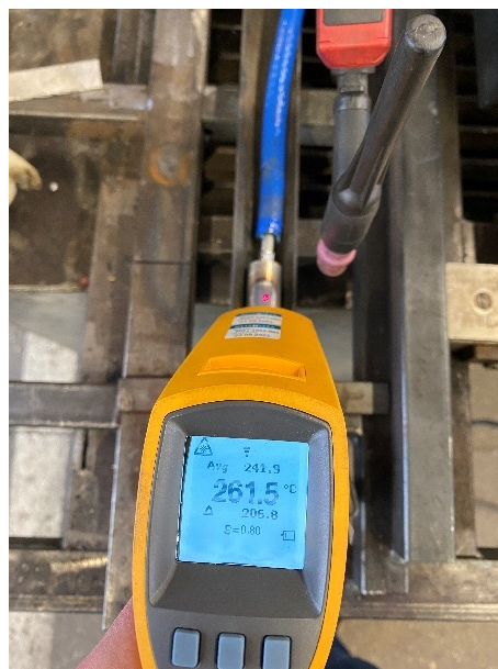
Slika 55 Mjerenje temperature površine navara
