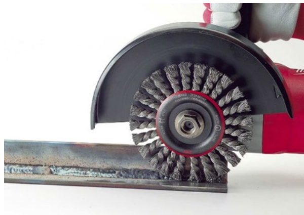
Slika 36 Brušenje zavora nakon zavarivanja [33]
