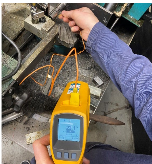
Slika 58 Mjerenje temperature uzorka tijekom rezanja
