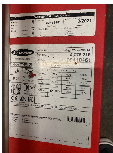
Slika 44 Identifikacijska pločica izvora struje za zavarivanje "MagicWave 230i"
