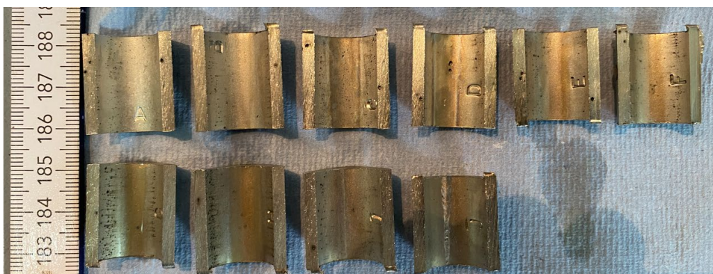
Slika 75 Uzorci nakon ispiranja i čišćenja četkom
