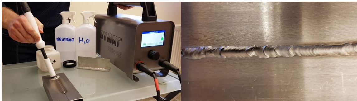
Slika 39 Ručno elektrolitičko čišćenje zavara [35]
