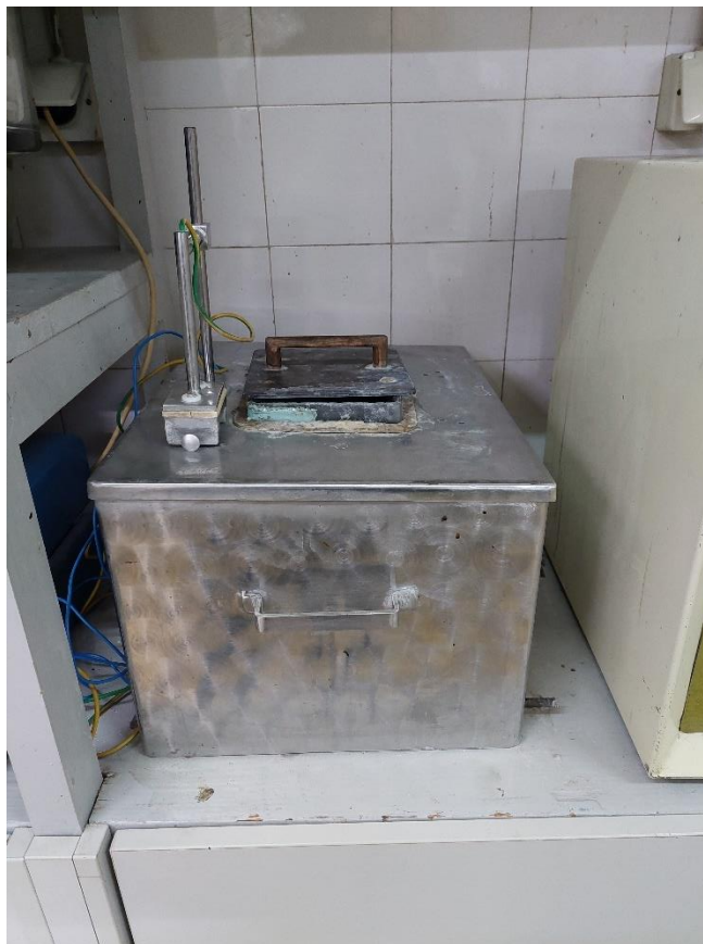
Slika 25. Stanica za elektrokemijsko nagrizanje
