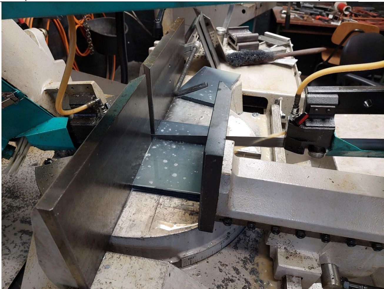
Slika 28. Rezanje pločica na tračnoj pili
