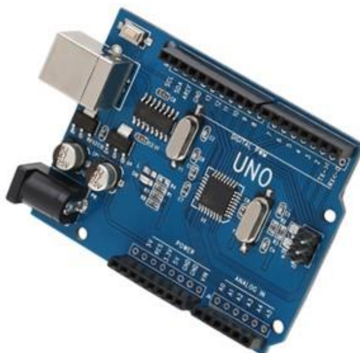
Slika 7. Arduino UNO R3 mikrokontroler
