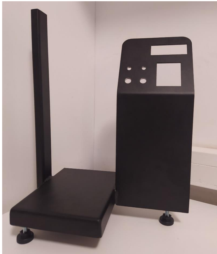
Slika 41. Konstrukcija nakon postupka elektrostatske plastifikacije
