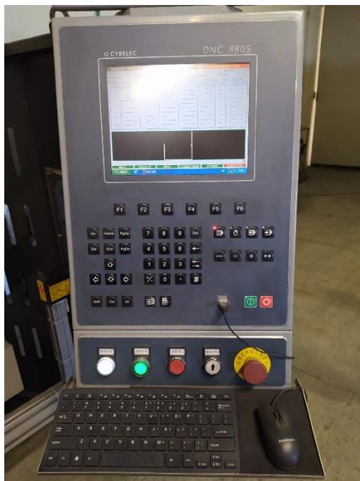
Slika 38. Korisničko sučelje uređaja za savijanje lima
