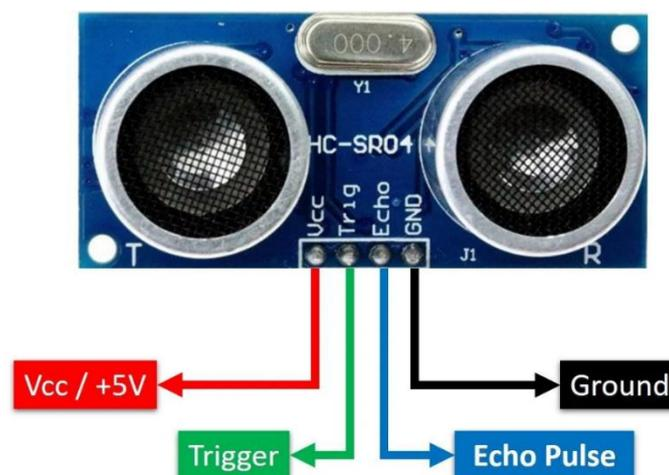
Slika 15. Priključci na senzoru udaljenosti
