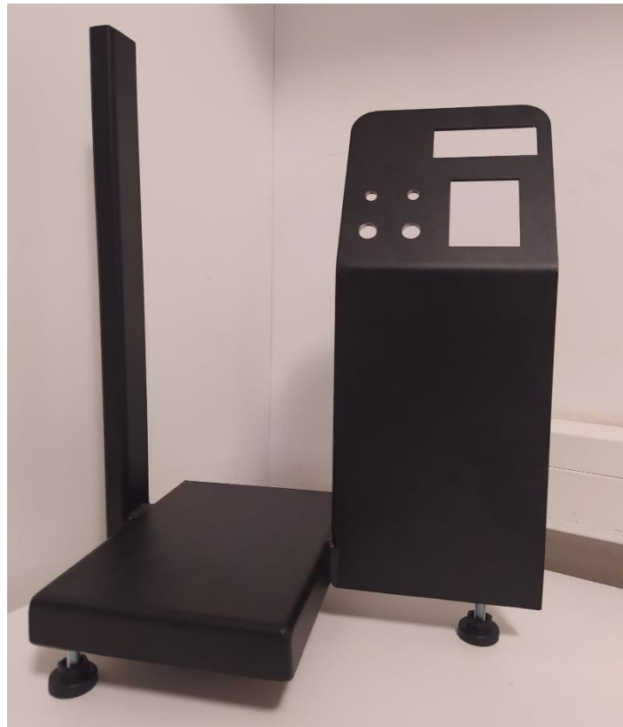
Slika 41. Konstrukcija nakon postupka elektrostatske plastifikacije
