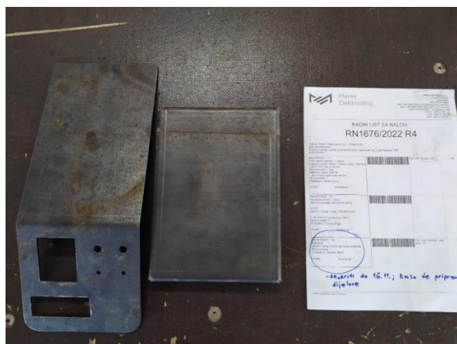
Slika 39. Dijelovi konstrukcije nakon savijanja
