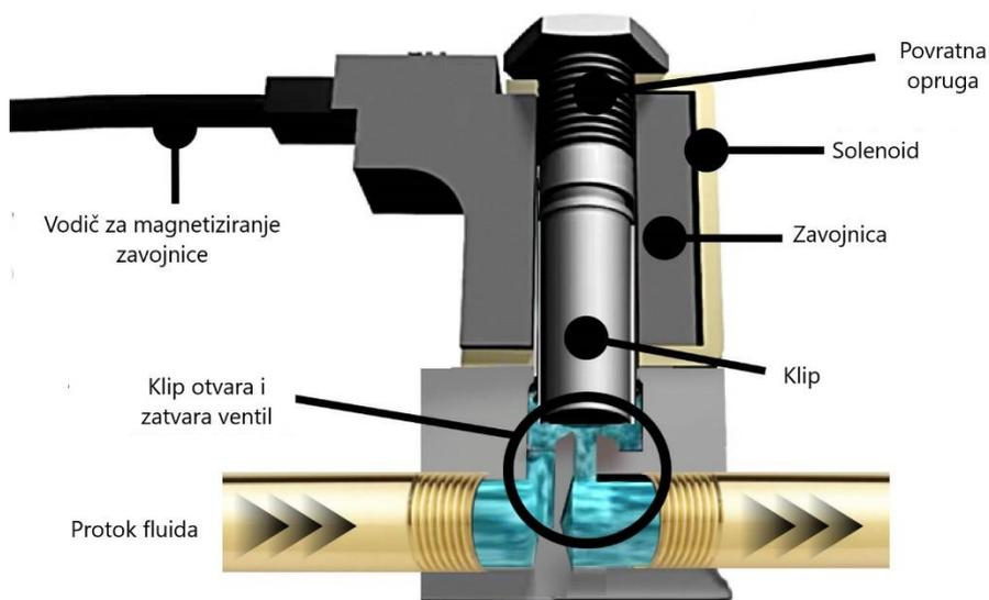
**Slika 21. Dijelovi elektromagnetskog ventila**
