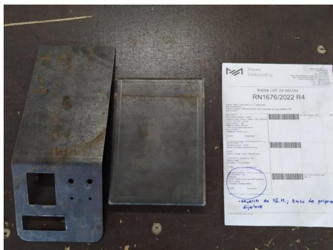
**Slika 39. Dijelovi konstrukcije nakon savijanja**
