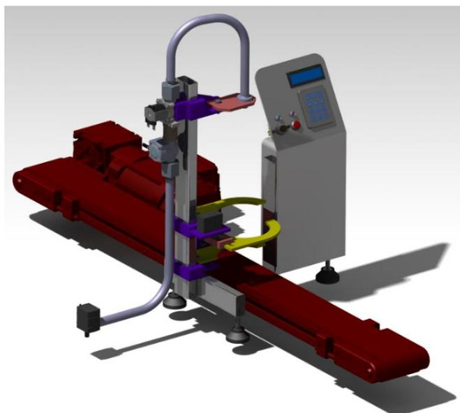
Slika 44. Idejno rješenje s implementiranom pokretnom trakom
