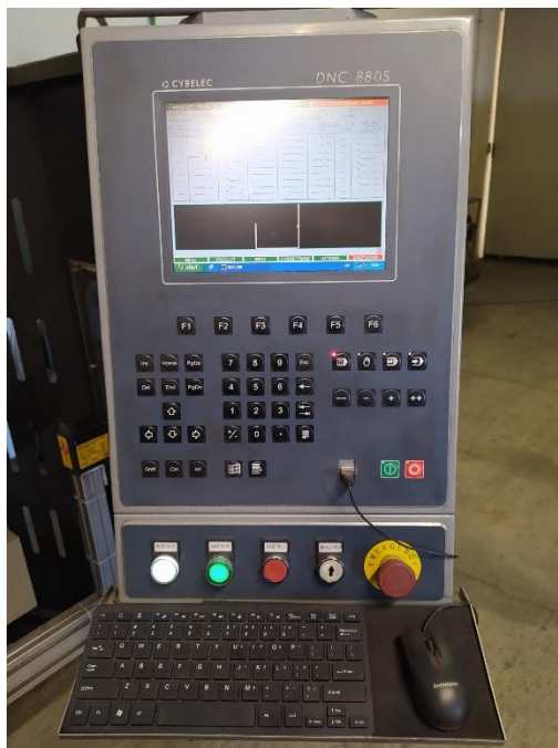
Slika 38. Korisničko sučelje uređaja za savijanje lima
