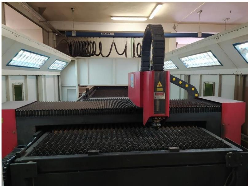
**Slika 36. Laserski rezač korišten za izradu konstrukcije uređaja**
