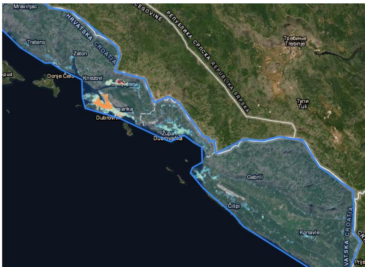
Slika 13. Potencijal primjene daljinskog grijanja za odabrano šire gradsko područje [155]
