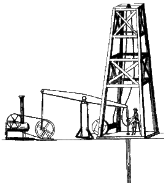
Slika 7 Bušenje kablskim alatom [10]
